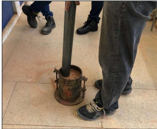
Figura 30: Ensaio de ISC como solo puro (a) imersão dos corpos de prova (b) execução do ensaio
