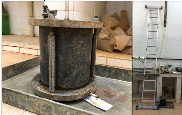
Figura 34: Ensaio de sedimentação de amostra da mistura 95(30F70S)5C
