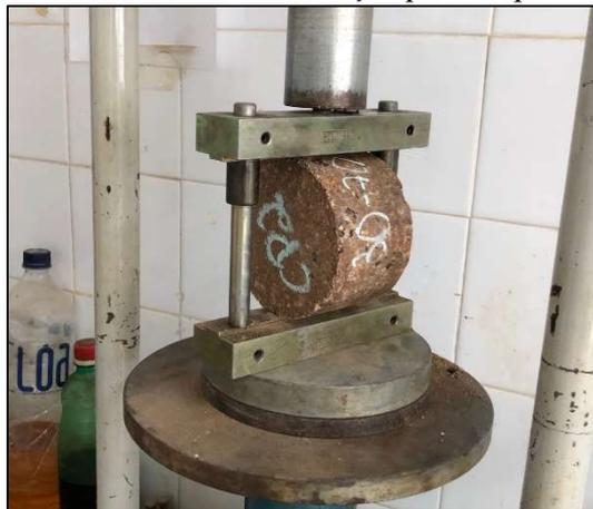
Figura 37: Ensaio de durabilidade
