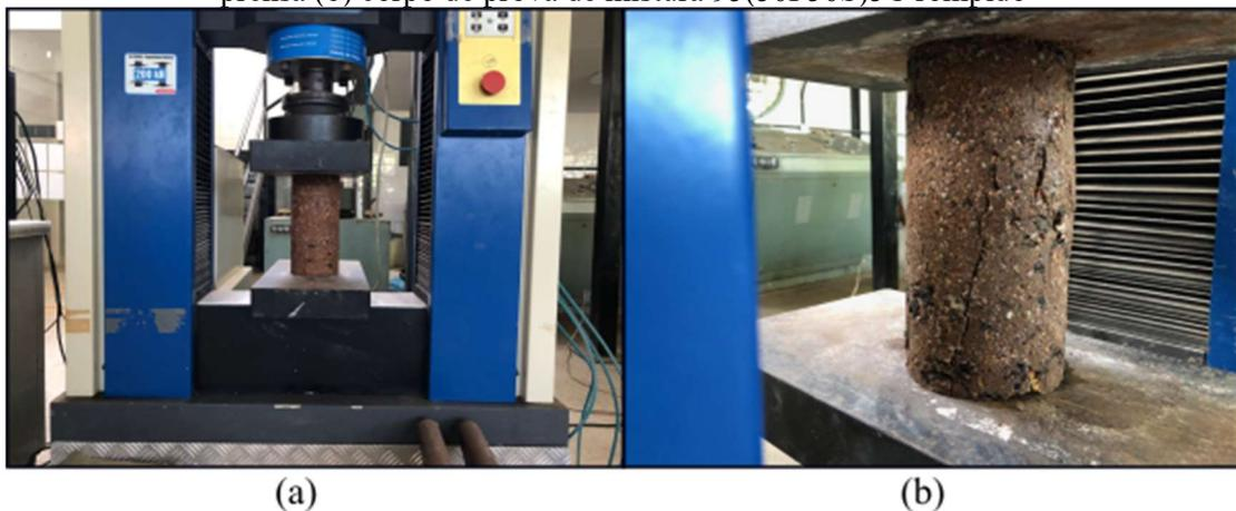
Figura 36: Ensaio de resistência à tração por compressão diametral
