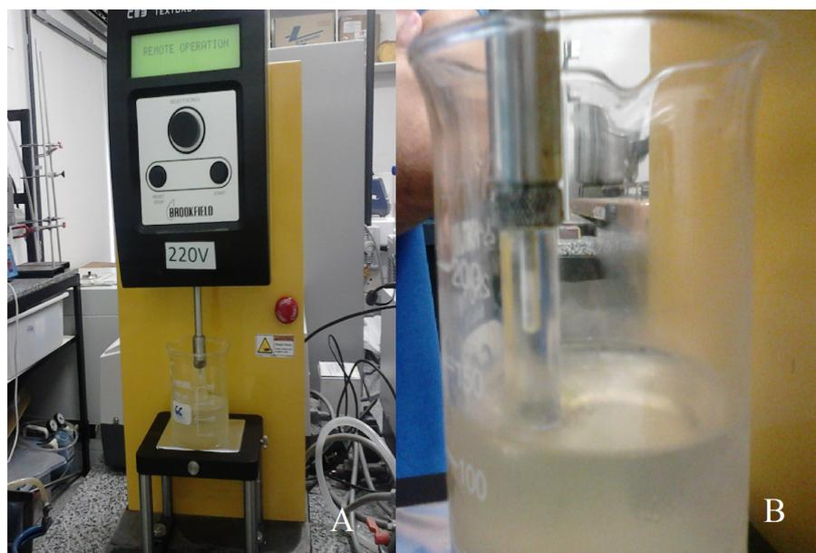
Figura 9 - (A) Equipamento CT3 Texture Analyzer. (B) Momento da depressão de 4mm da superfície da gelatina.
