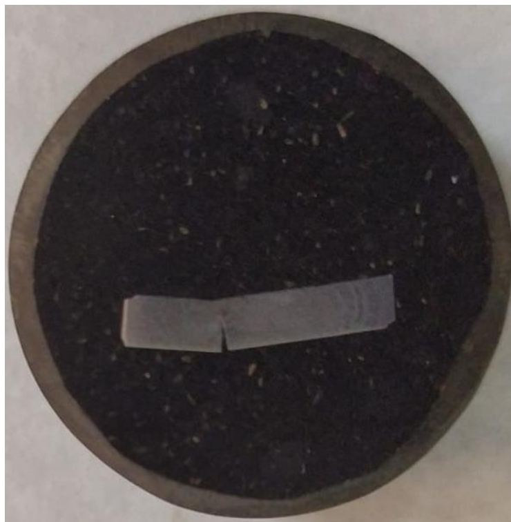
Figura 5-4. CP (alternado) fraturado por fadiga, embutido em baquelite para realização da metalografia.
