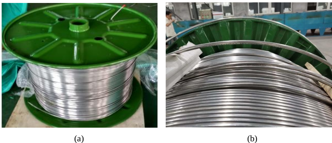
Figura 3-6. Tubo de umbilical fabricado por laminação, em seguida é bobinado em carretel.
