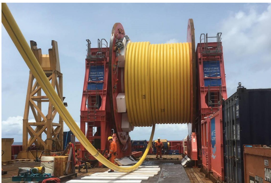
Figura 3-7. Umbilical bobinado em carretel após sua fabricação. Fonte: MDL [28].
