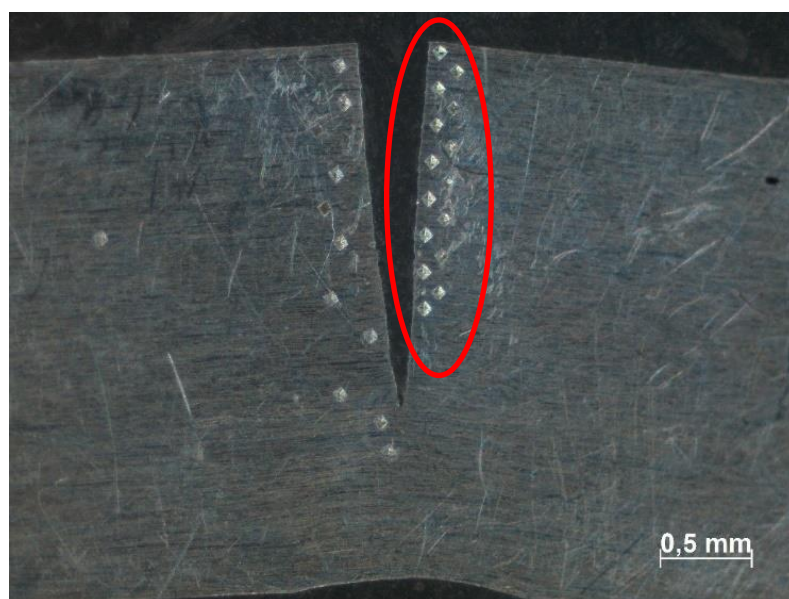
Figura 5-5. Sinalização em CP fraturado onde foi medida a microdureza.
