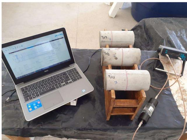
Figura 17: disposição das amostras cilíndricas e do equipamento de ultrassom para realização do ensaio.
