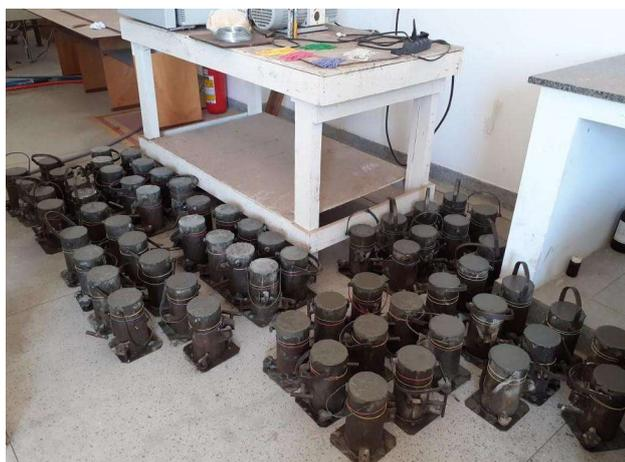
Figura 12: amostras cilíndricas em fase de “pega” durante a confecção.
