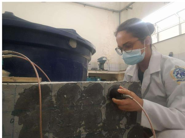
Figura 19: ensaio ultrassônico na viga 1.
