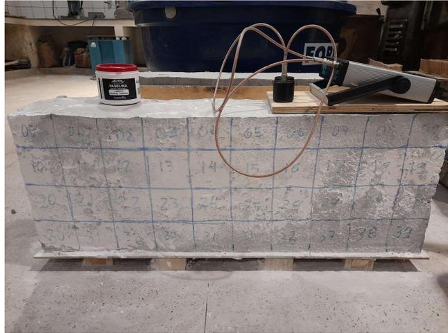
Figura 18: Viga 2 antes do ensaio ultrassônico.
