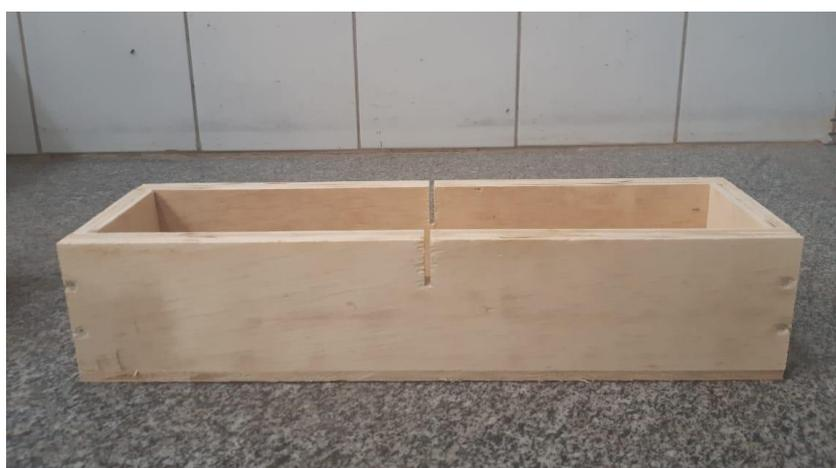
Figura 11: Molde de madeira para moldagem dos espécimes prismáticos. Os entalhes no centro e acima do molde servem para inserir a lâmina para concretar o CP contendo o entalhe para mecânica da fratura.
