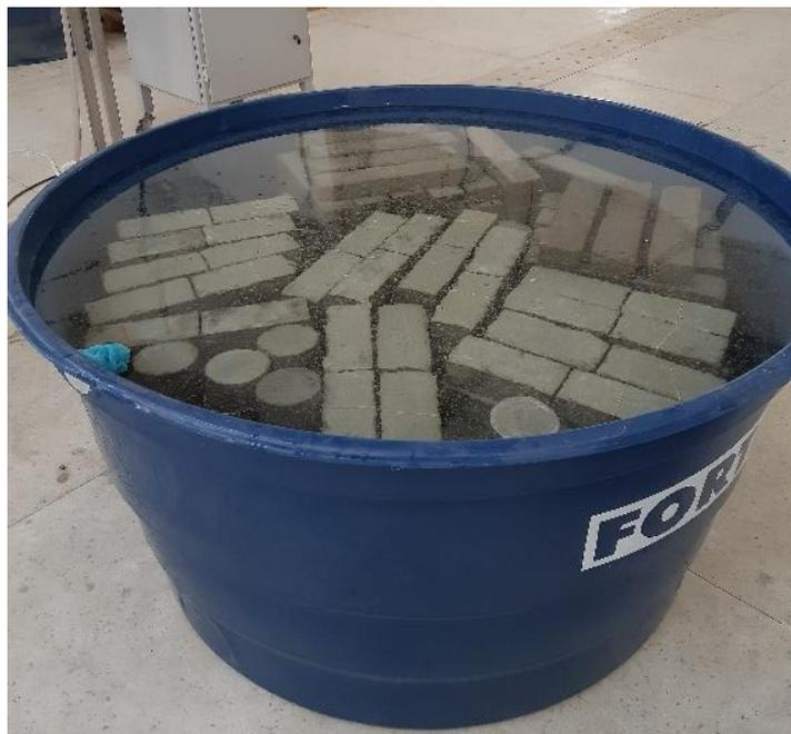
Figura 13: Corpos de prova em tanque para cura úmida. Observam-se os CPs prismáticos contendo entalhe e os CPs cilíndricos para compressão.
