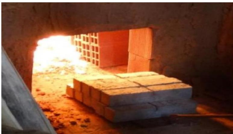
Figura 14: Corpos de prova prismáticos sendo inseridos no forno para aquecimento.
