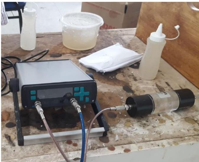
Figura 15: Procedimento de calibragem do equipamento de ultrassom.
