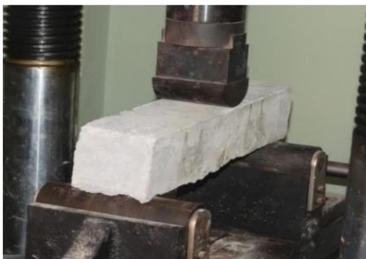
Figura 17: Ensaio de flexão em três pontos em corpo de prova prismático.
