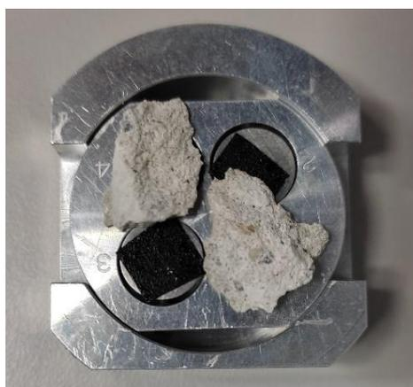
Figura 18: Amostra de concreto no porta amostra do equipamento de microscopia eletrônica.
