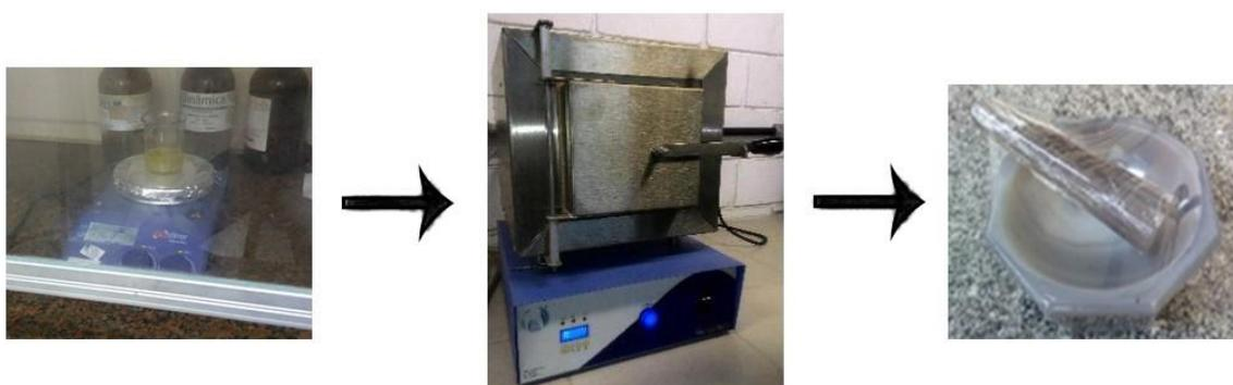
*Figura 8: Caminho percorrido por cada amostra, da esquerda para a direita: O sol aquecido no agitador magnético a 120°C por 2 horas na capela. Depois, o xerogel calcinado a 900°C por 2 horas no forno. Por fim, o equipamento usado para macerar a amostra.*
