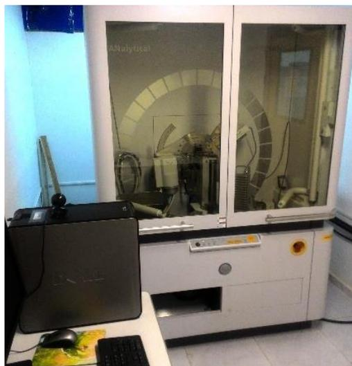
*Figura 9: Difratorômetro EMPYREAN SERIES 2 usado para produzir todas as medidas de DRX.*
