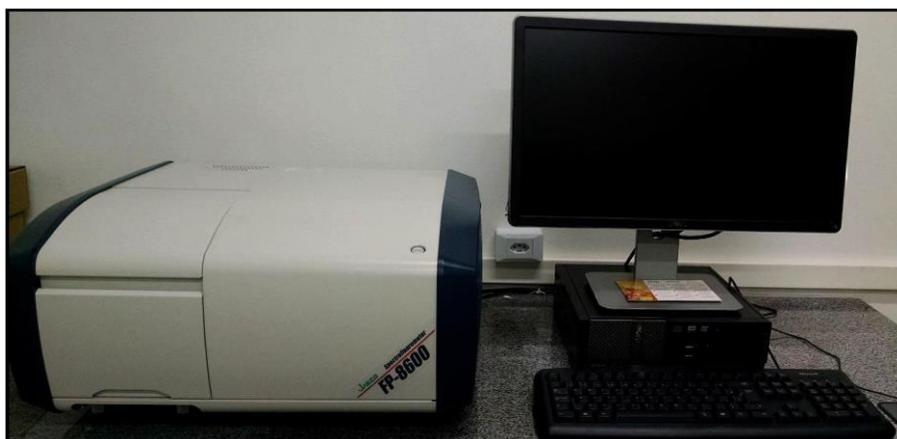
*Figura 10: Espectrofluorímetro modelo FP-8600 usado para realização das medidas de fotoluminescência. Retirada da Ref. [18].*
