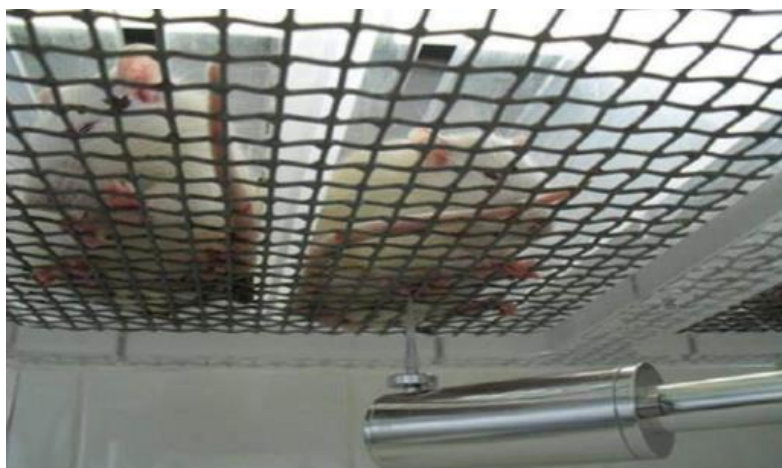
Figura 1: Aparato de mensuração, von Frey eletrônico. Fonte: Arquivo do Laboratório de pesquisa em neurociências – UFS.
