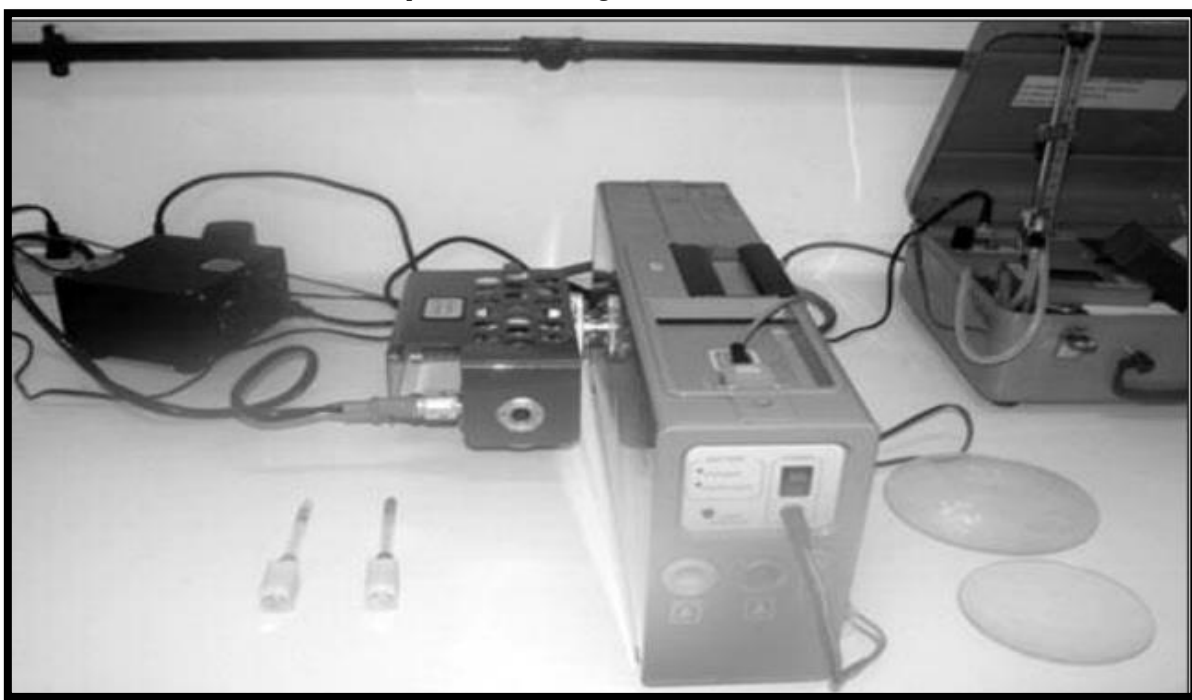
Figura 4- Apresentação física do analisador quantitativo que converte em dados a presença de mercúrio em amostras de diversas formas físicas, líquidas, sólidas ou gasosas.
