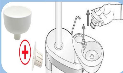
FIG. 05: FILTRO NAS CUSPIDEIRAS, PARA EVITAR QUE RESÍDUOS DE AMÁLGAMA CAIAM NO ESGOTO.
