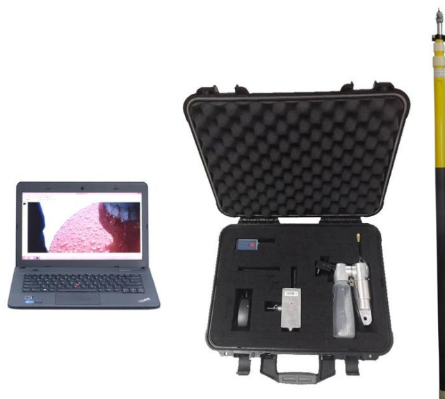
Figura 1 - Conjunto de teste GD-710 para propriedades hidrofóbicas de isoladores compostos.
