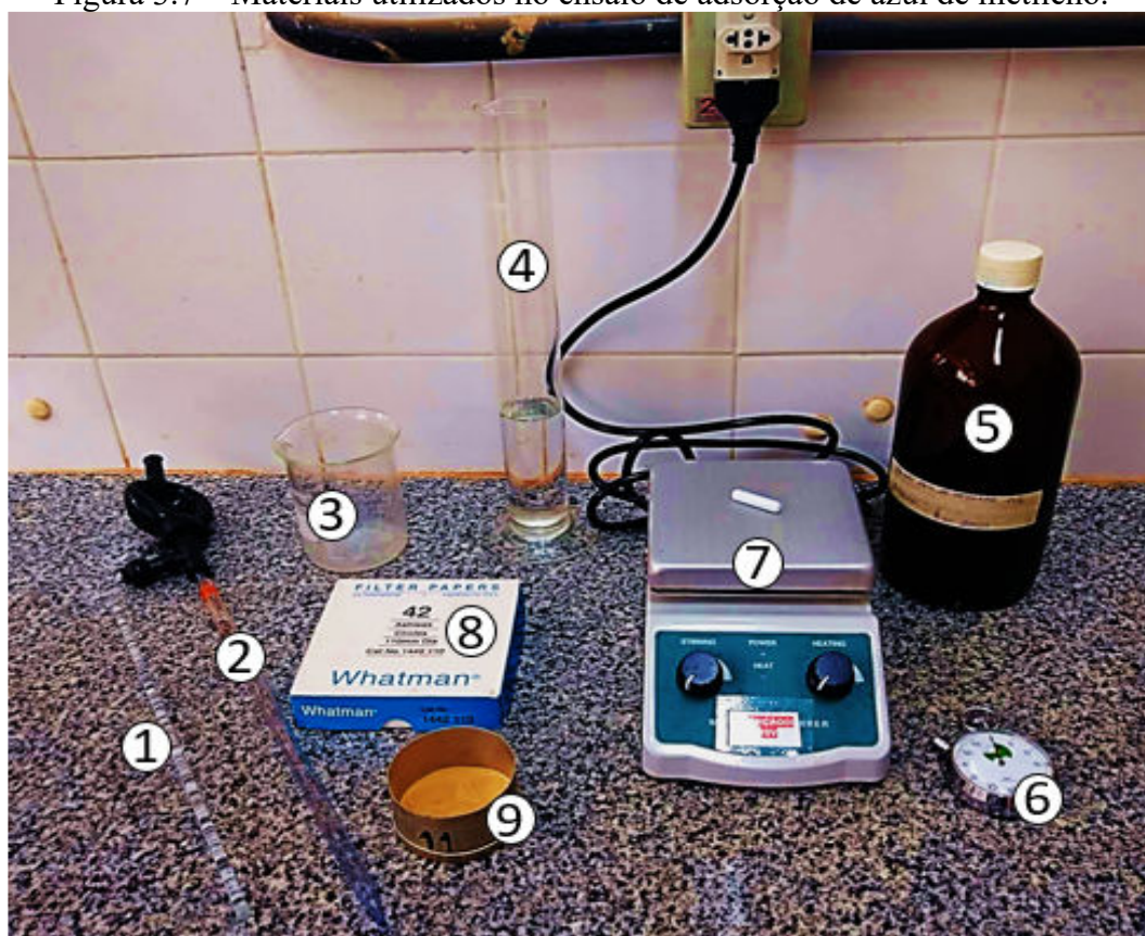
Figura 3.7 – Materiais utilizados no ensaio de adsorção de azul de metileno.
