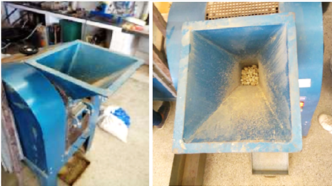
Figura 3.6 – Britador de mandíbula utilizado para o destorroamento primário da amostra.
