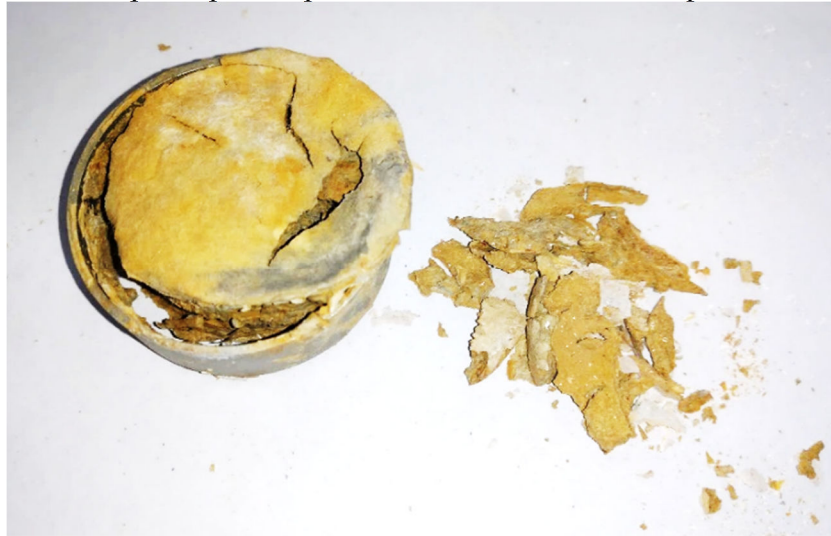
Figura 4.15 – Corpo de prova após o término do ensaio de expansão livre cíclico.
