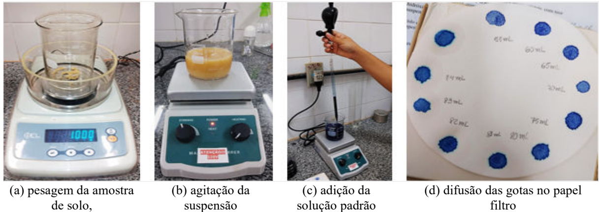
Figura 3.8 – Sequência do ensaio de adsorção de azul de metileno.
