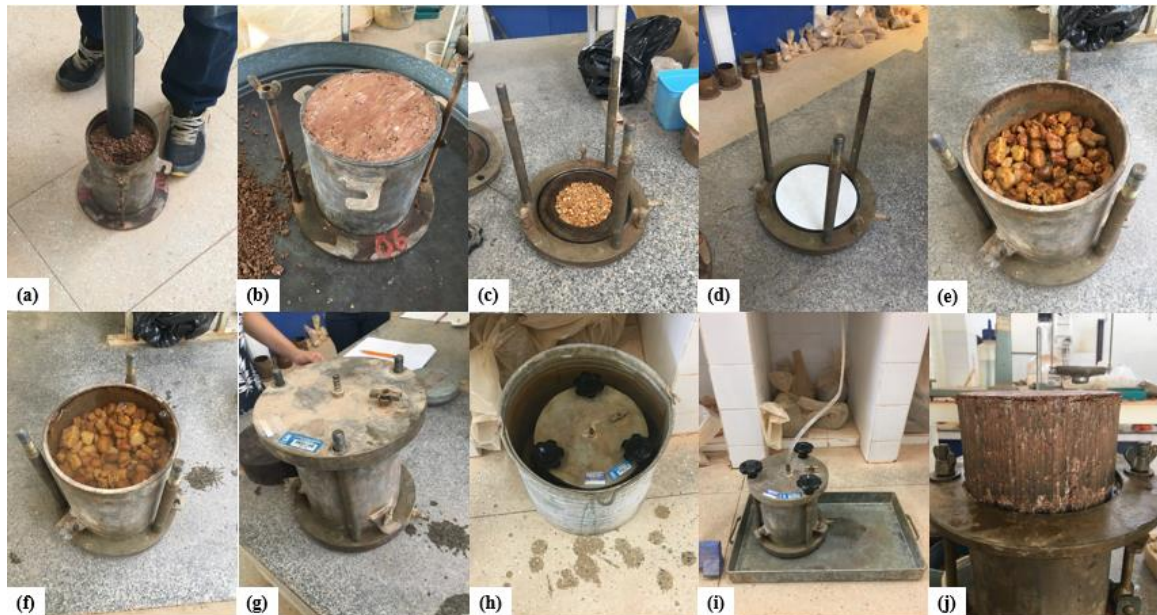
Figura 29: Etapas realizadas no ensaio de permeabilidade, (a) compactação do corpo de prova, (b) corpo de prova compactado, (c) preparação da base do permeâmetro, (d) aplicação do papel filtro sobre a camada de areia, (e) corpo de prova posicionado sobre a base e sobreposto por papel filtro e uma camada de areia grossa, (f) cilindro preenchido com água, (g) inserção da tampa superior, (h) processo de saturação, (i) execução do ensaio, (j) extração do corpo de prova.
