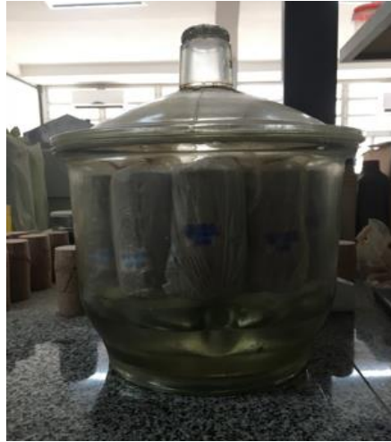
Figura 21: Corpos de prova moldados para o ensaio de resistência à compressão não confinada no dessecador antes do rompimento.
