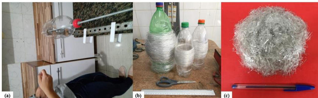
Figura 15: Etapas da preparação do PET filete: (a) formação dos fios de PET, (b) fios de PET obtidos e acessórios utilizados (tesoura e régua) para confecção dos filetes, (c) filetes.
