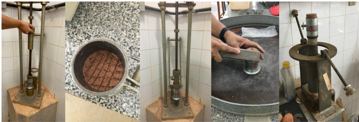
Figura 20: Procedimento para moldagem dos corpos de prova por compactação dinâmica.
