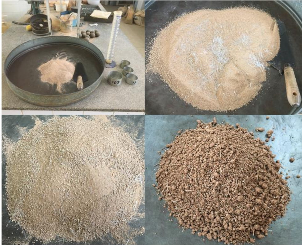
Figura 18: Procedimento para preparação da mistura solo-PET filete.
