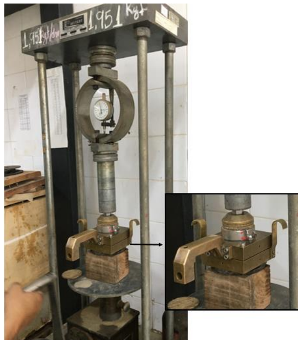
Figura 25: Extração dos corpos de prova de cisalhamento direto.
