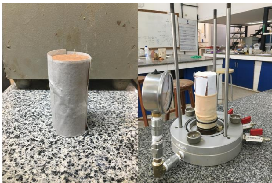
Figura 27: Corpo de prova das misturas solo-PET filete revestido com tiras de papel antes de ser envolvido com a membrana.
