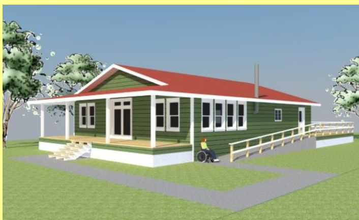
Figura 16: Residência acessível, escada na frente e rampa de acesso ao fundo: acesso excludente.
