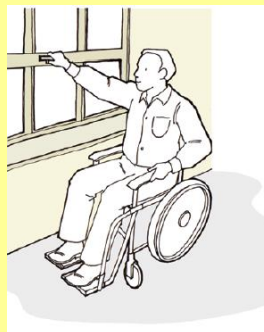
Figura 29: Janela com sistema de alavanca de fácil abertura
