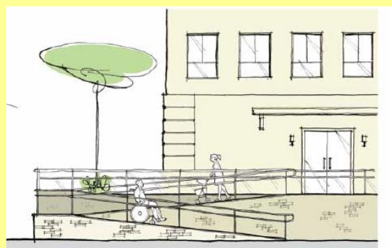
Figura 19: Acesso seguro a um edifício com rampas, corrimão e guarda-corpo.
