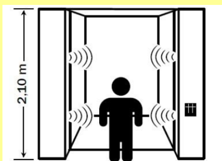
Figura 26: Elevador com sensores
