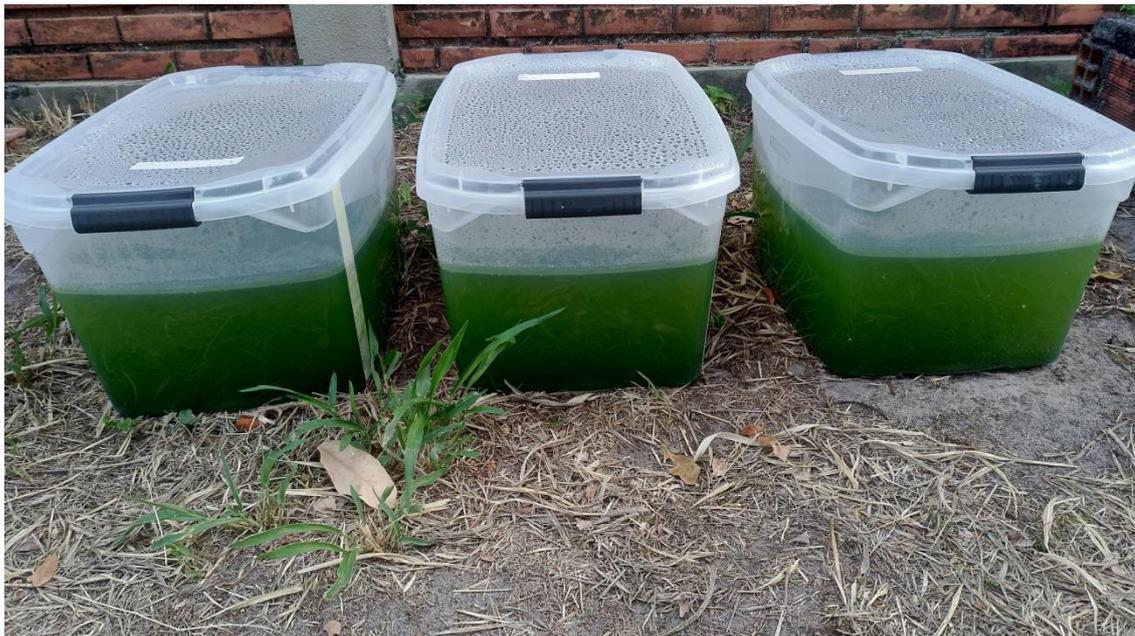
Figura 4 - Tratamento terciário de efluente com microalga *Chlorella vulgaris* contendo 20 L de efluente e 2 L de inóculo em cada tanque.
