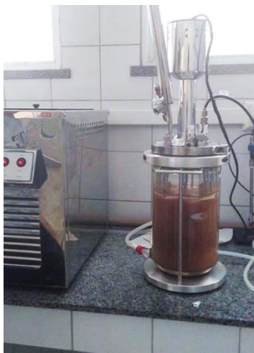
Figura 7 – Biorreator de bancada, em processo de fermentação.
