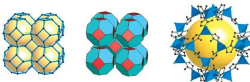
Figura 1 – Estrutura polimérica de complexos metálicos, característica das MOFs.
