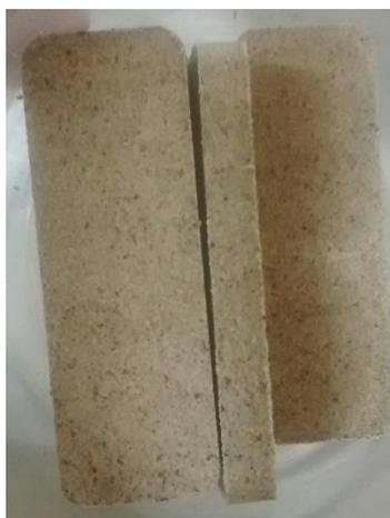
**Figura 8** - Pastilhas da torta via *soxhlet* da moringa para alimentação no reator.
