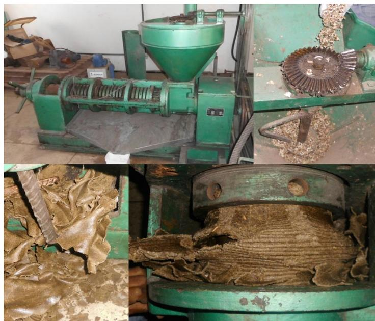
**Figura 5** - Extração da torta em prensa extratora.
