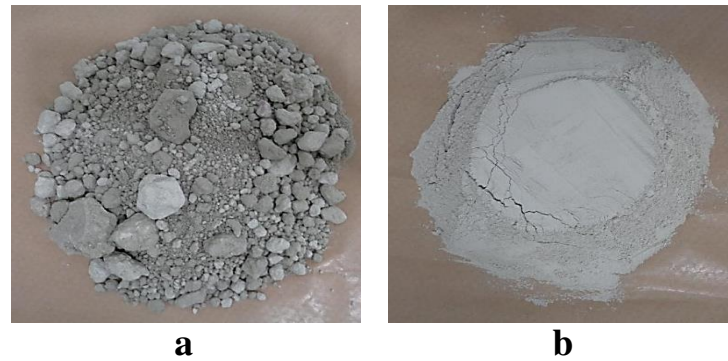
Figura 6: Aspectos do calcário in natura (a) e após passagem pelo moinho de disco (b).
