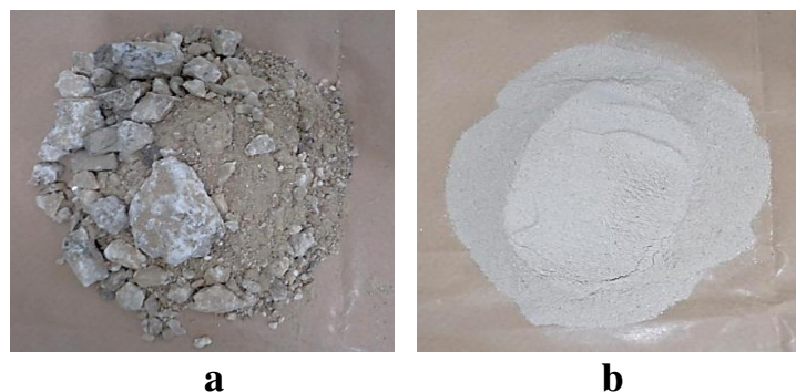
Figura 5: Aspectos da gipsita antes da preparação (a) e após passagem pelo moinho de disco (b).
