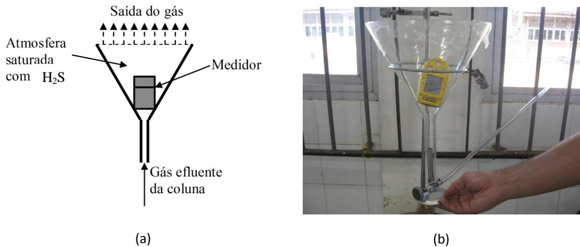
Figura 3 – Esquema de Unidade de dessulfurização (a); Unidade de dessulfurização (b)
