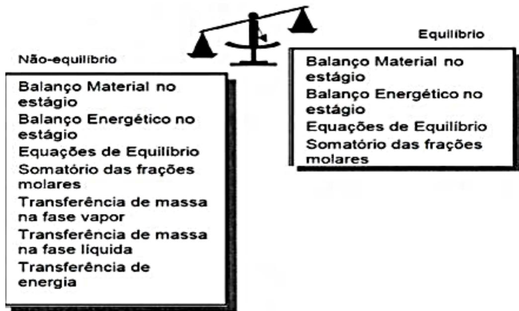
Figura 12 - Comparativo entre os modelos de equilíbrio e não equilíbrio
