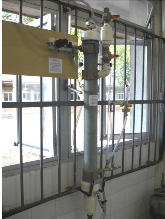
Figura 2 – Reator de dessulfurização
