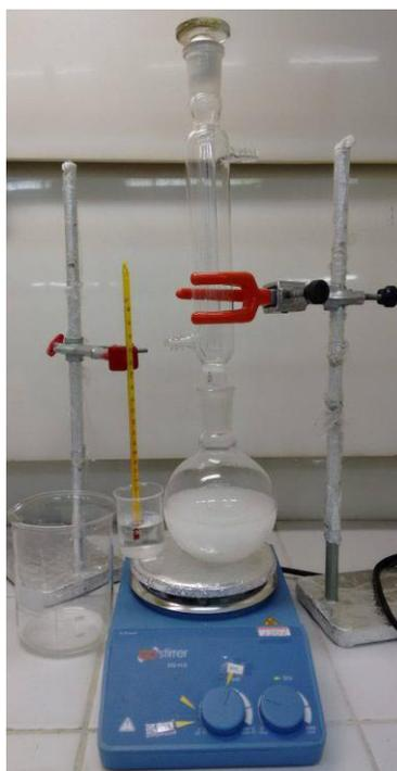
Figura 18 - Ilustração do sistema utilizado para a troca iônica
