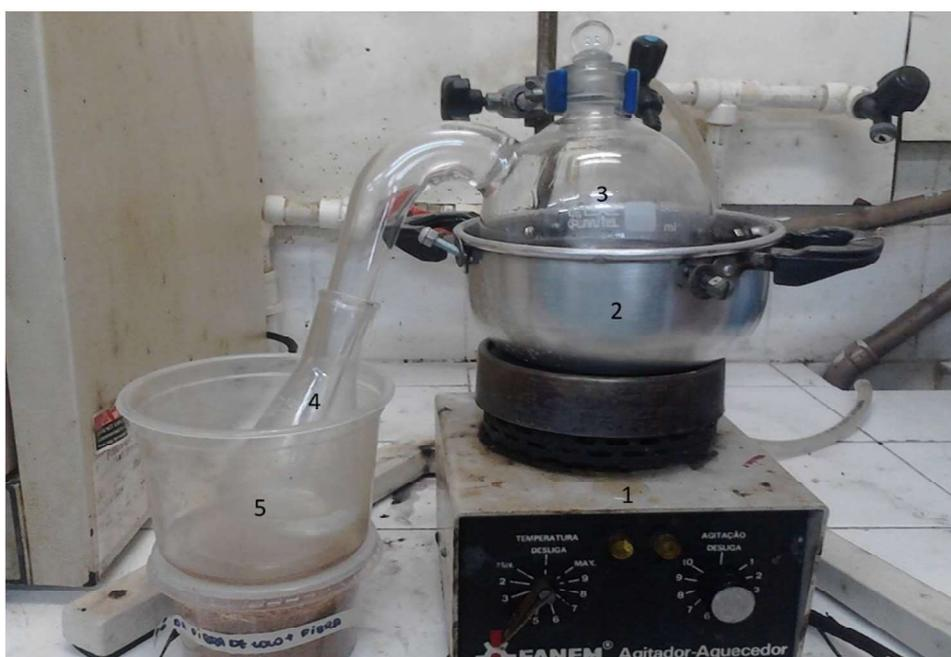
Figura 5.1 - Aparato experimental para produção de cloreto de metacrilóila.
