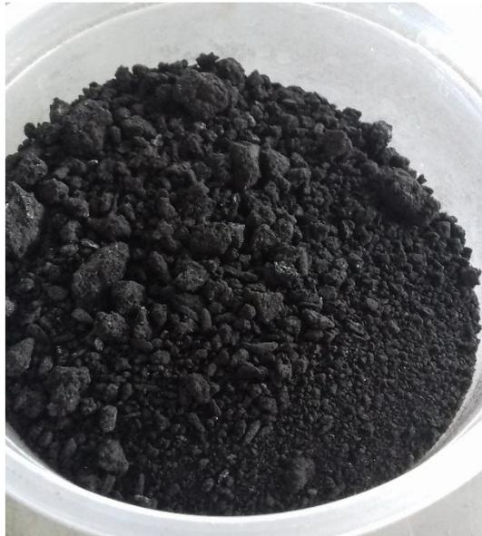
**Figura 7** – Carvão ativado obtido através da vagem da *Moringa oleifera* Lam
