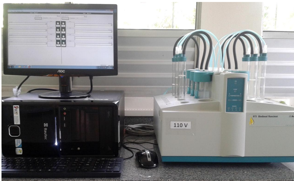
Figura 10 - Equipamento Rancimat utilizado para medir a estabilidade à oxidação
