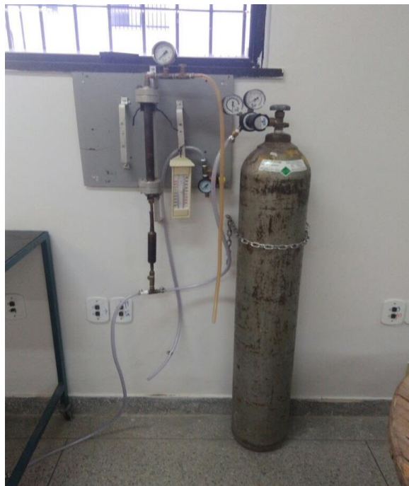
Figura 5- Coluna de adsorção montada em escala de laboratório.
