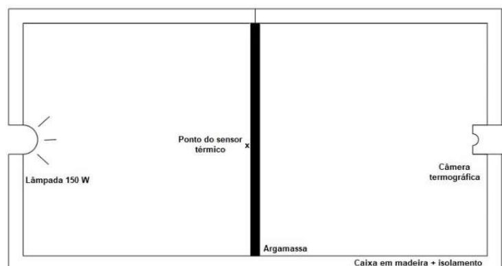
Figura 15: Esquema da caixa utilizada no ensaio de comportamento térmico.
