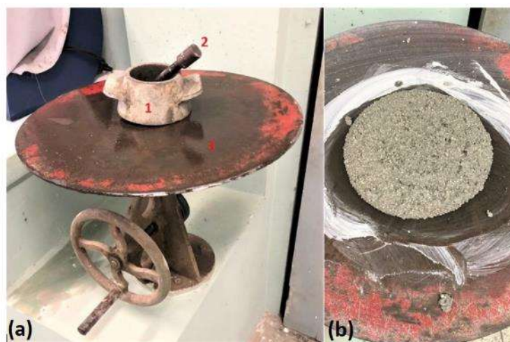
Figura 4: Ensaio do índice de consistência – (a) Equipamentos; (b) Argamassa após ensaio.
