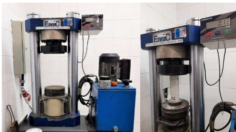
Figura 8: Ensaio de resistência mecânica à compressão – Equipamento.
