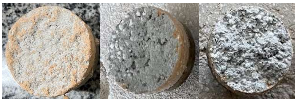
Figura 35: Ruptura do tipo coesiva constatadas nas argamassas com adição de EPS em um percentual de 0%, 60% e 75%, respectivamente.
