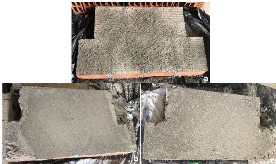
Figura 11: Protótipo da parede para o ensaio de resistência de aderência à tração – (a) Aplicação do chapisco; (b) e (c) Camada da argamassa com o percentual de adição do EPS.
