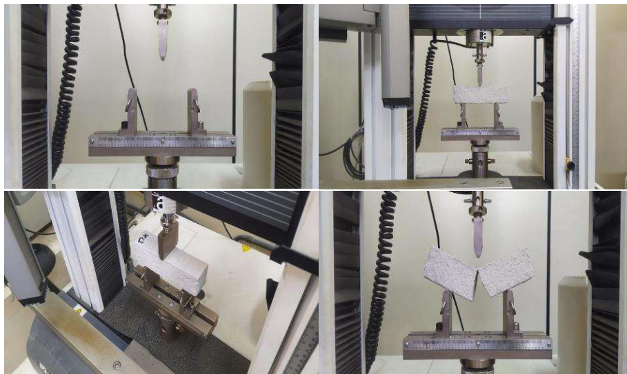
Figura 9: Ensaio de resistência à tração na flexão – Equipamento e etapas do ensaio.
