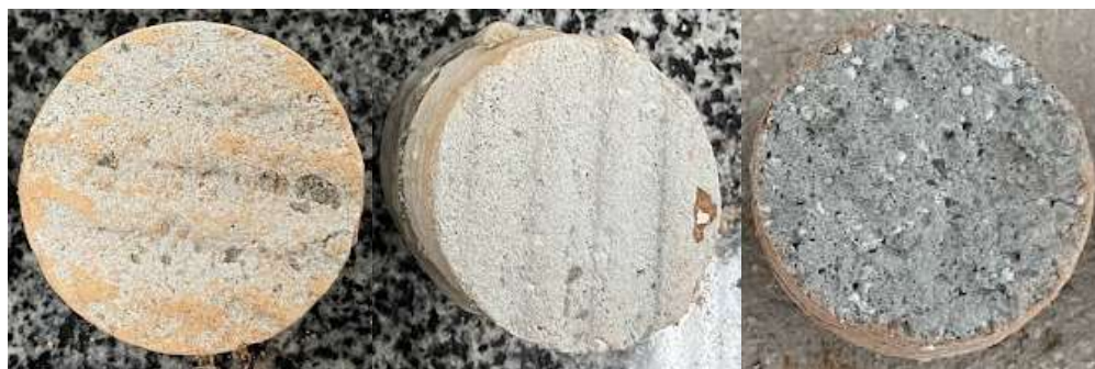
Figura 36: Ruptura do tipo adesiva constatadas nas argamassas com adição de EPS em um percentual de 15%, 30% e 45%, respectivamente.
