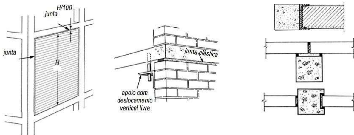
Figura 9 – Juntas elásticas de dilatação
