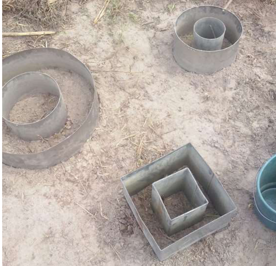
Figura 4. Duplo cilindro infiltrômetro, duplo cilindro infiltrômetro reduzido e duplo infiltrômetro quadrado instalados em campo.
