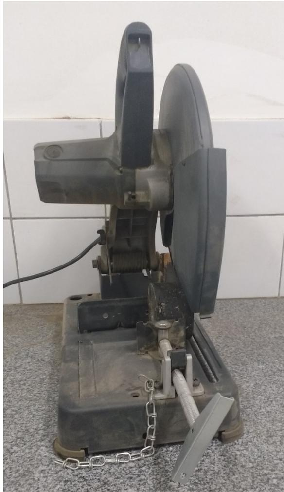
Figura 22 - Serra policorte usada na confecção do CPs.
