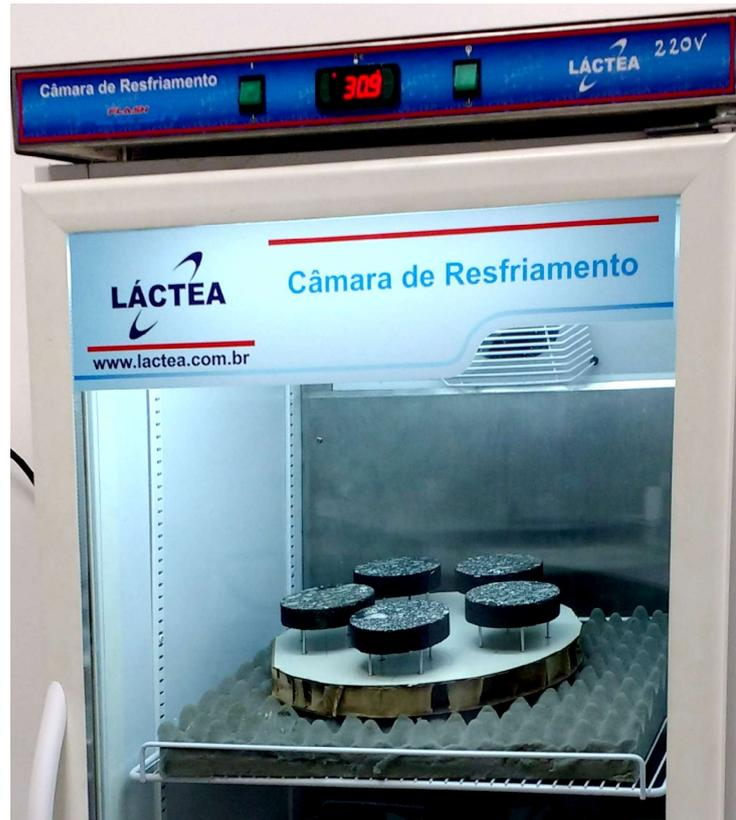
Figura 20 - Câmara com pórtico e CP para ensaio de ressonância por impacto.
