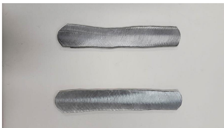
Figura 19. Ligas do sistema Ti-Nb-Y após etapa de laminação a quente e remoção da camada de óxido.
