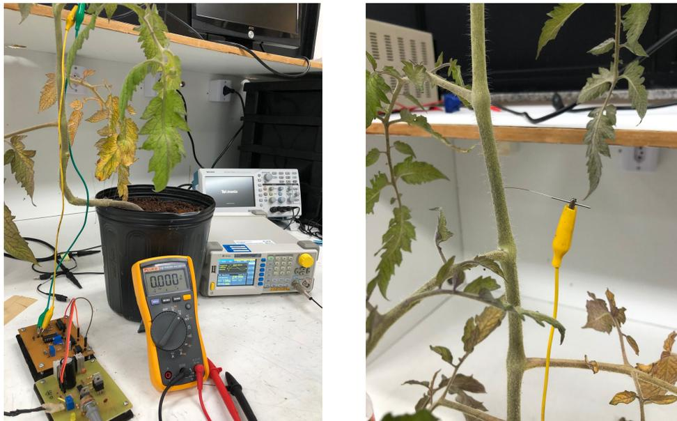
Figura 5.15: Forma de conexão entre eletrodos e PCI do sensor desenvolvido, através de cabos jacaré-jacaré.
