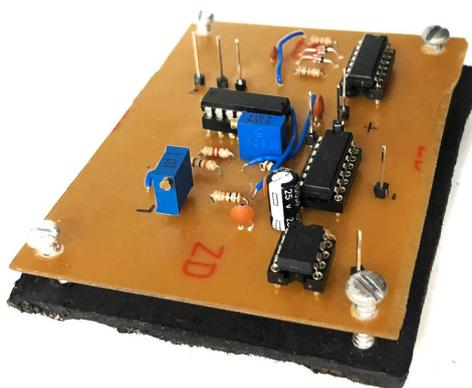
Figura 5.13: Placa de circuito impresso do sensor de fase da bioimpedância do tecido das plantas desenvolvido neste plano de trabalho.
