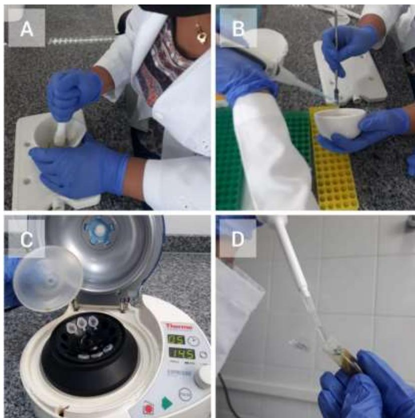
FIGURA 5. Extração de DNA de *Spondias tuberosa* Arr. Câm. A - Maceração das folhas; B - adição do mercaptoetanol; C - centrifugação; D - separação da fração contendo DNA de restos vegetais. UFS, São Cristóvão, SE.
