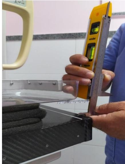
Figura 1. Paquímetro adaptado e nível de bolha sendo utilizados para as medições de desvio do alinhamento da bandeja de compressão.
