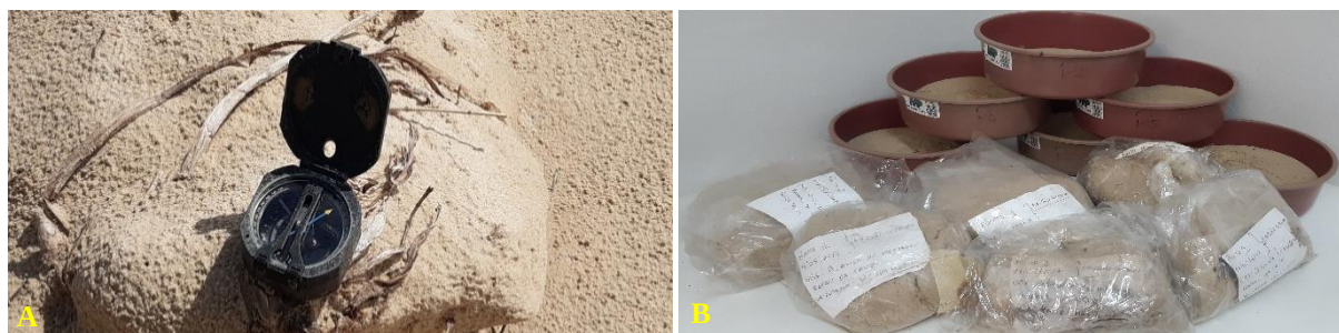
Figura 5: A) Bússola geológica utilizada para aferição da declividade de face praial; B) Sedimentos arenosos coletados em praia para análise granulométrica.
