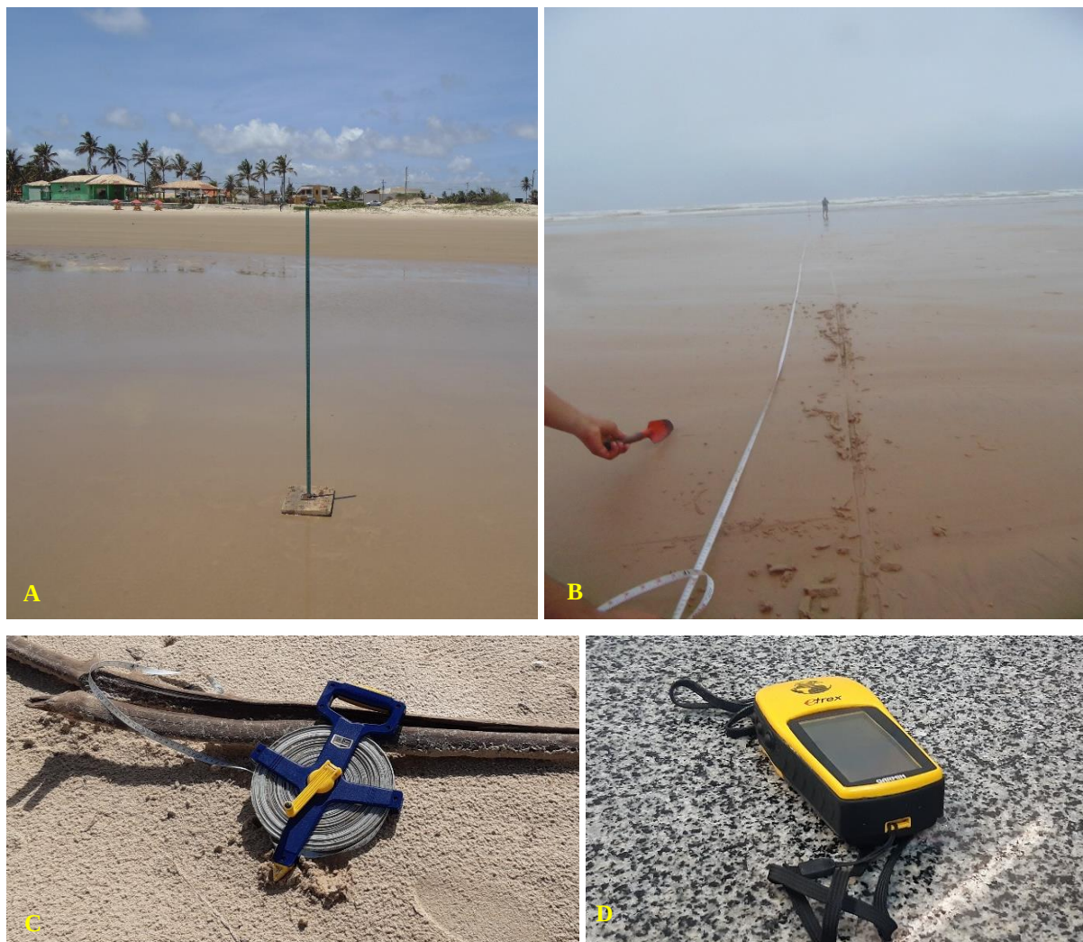
Figura 3: A) Alinhamento transversal de balizas para verificação da diferença altimétrica entre os dois pontos cotados; B) Medição transversal do estirâncio e do distanciamento entre as balizas nos desníveis topográficos com o uso da fita métrica; C) Fita métrica utilizada para medição transversal da faixa de praia; D) GPS de navegação para marcação e georreferenciamento de pontos.
