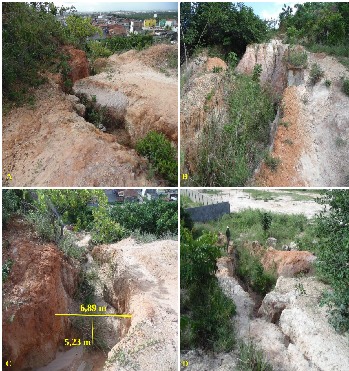
Figura 74: A, B, C e D – Segmentos de uma mesma voçoroca, no sentido topo/base, evidenciando estágio avançado do processo erosivo no Bairro Cidade Nova.
