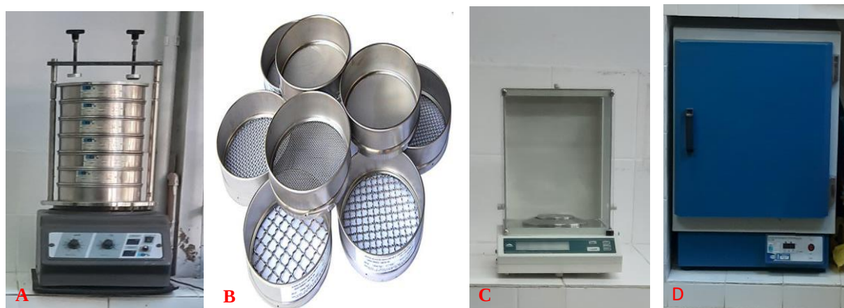
Figura 8: Equipamentos utilizados em laboratório para análise granulométrica dos sedimentos coletados em praia: A) Agitador eletromagnético com peneiras granulométricas para separação dos sedimentos arenosos; B) Peneiras granulométricas; C) Balança analítica para pesagem dos sedimentos e D) Estufa de esterilização e secagem de sedimentos com controlador de temperatura automático.
