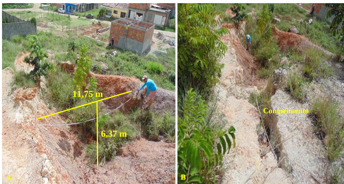
Figura 76: A e B – Medições morfométricas (largura, comprimento e profundidade) de uma mesma voçoroca em estágio avançado de evolução com segmento ravinado, Bairro Cidade Nova.
