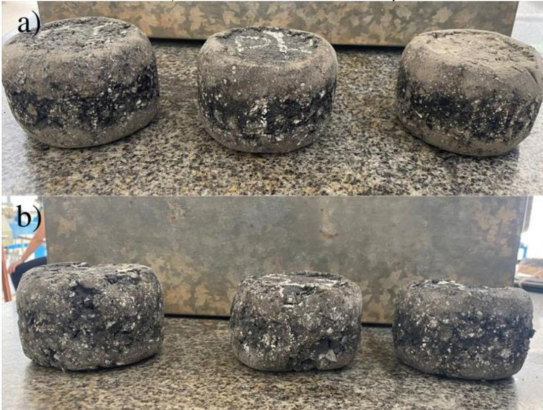
A Figura 28 mostra corpos de prova das misturas asfálticas com ligante CAP 50/70 não modificado e modificado, por via seca, após o ensaio de desgaste por abrasão. Observa-se que o CAP 50/70 não modificado apresenta uma coesão maior em relação ao modificado, uma vez que a perda de massa foi menor, isto é, 1,11% massa/massa, enquanto que para a mistura asfáltica com o CAP 50/70 modificado a perda de massa foi de 4,4% massa/massa.
