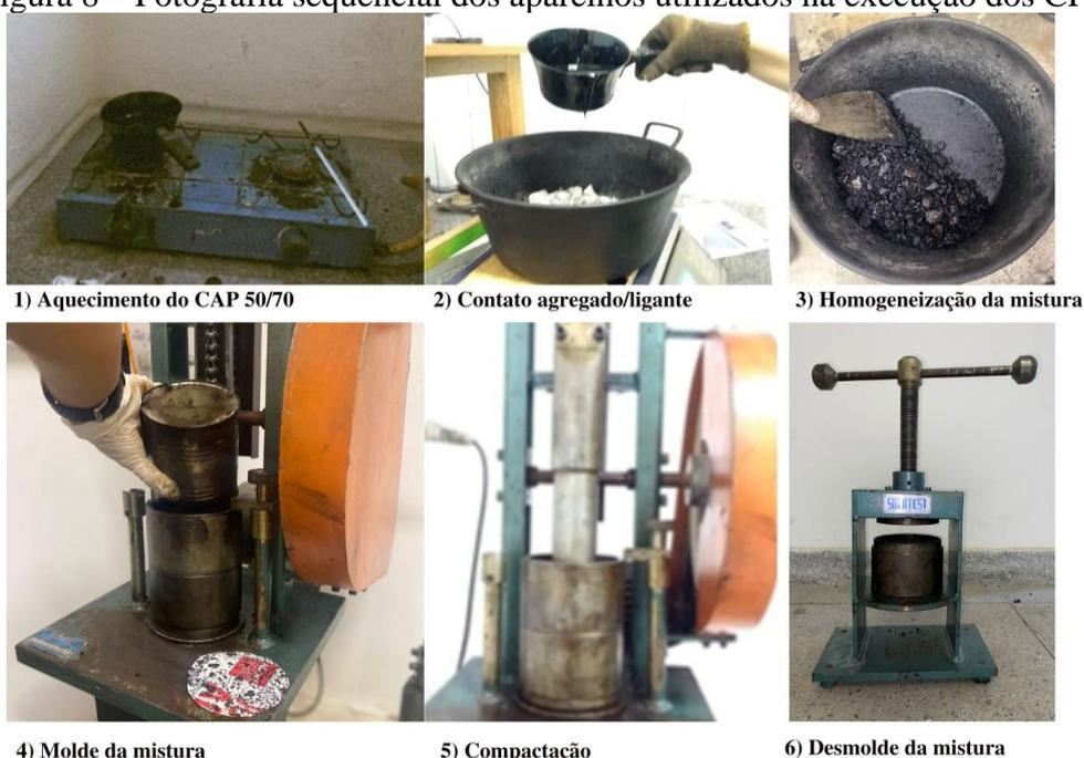
Em seguida, após o processo de compactação e desmolde, os corpos de prova foram resfriados em temperatura ambiente e, assim, realizou-se as medidas de altura e diâmetro, massa seca e massa submersa. Com esses valores foi possível se obter os parâmetros volumétricos.
