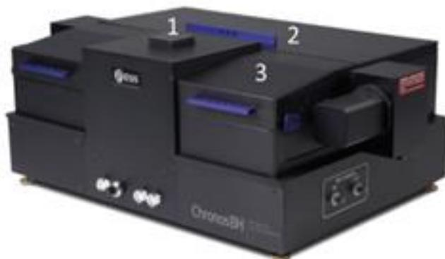
Figura 3.11 – Espectrômetro ISS Chronos-BH. Compartimento em que estão montados: 1) porta amostra; 2) monocromador de excitação e detector PMT; 3) laser de excitação e acessórios de ajuste [SSI *focus and discover*].
