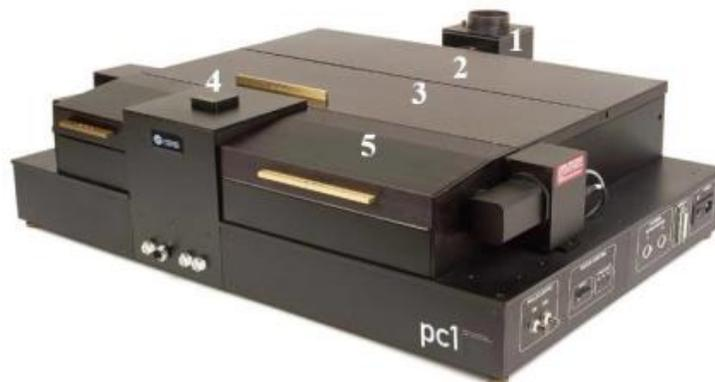
Figura 3.9 - Espectrofluorímetro ISS-PC1. Compartimento em que estão montados: 1) fonte de excitação luminosa; 2) monocromador de excitação; 3) acessórios de ajuste da luz de excitação; 4) porta amostra; 5) conjunto de lentes e espectrômetro para o caminho óptico de emissão [SSI *focus and discover*].
