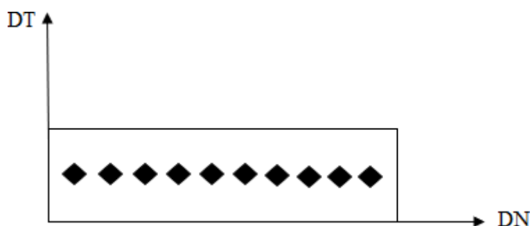
Figura 25: Representação esquemática dos pontos da amostra onde foram realizadas os ensaios de microdureza Vickers. DN – Direção Normal de deformação; DT - Direção transversal de deformação.
