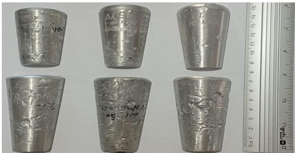
Figura 18: Os três lingotes produzidos na CPF na parte superior da figura e os três lingotes produzidos na CPE na parte inferior da figura.
