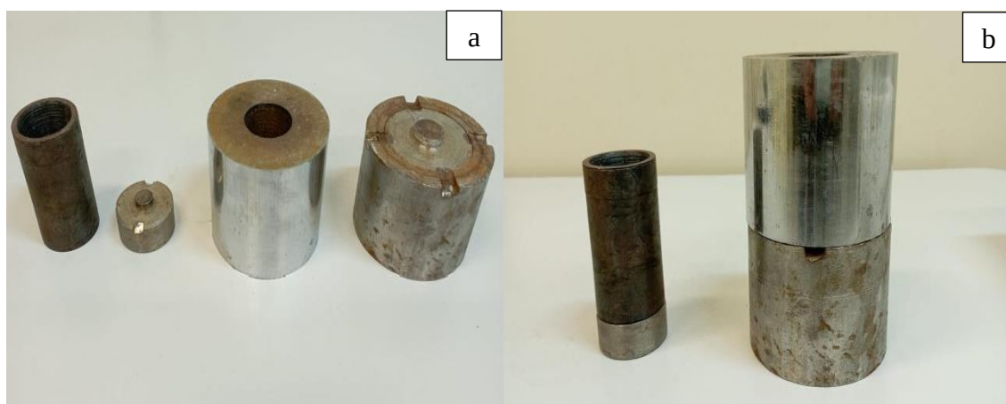
Figura 15: Coquilhas com base e corpo separados (a). Coquilhas montadas (b).
