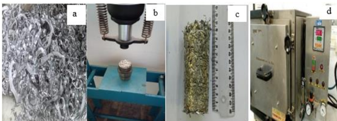
Figura 17: Alumínio na forma de cavaco (a), compactação do cavaco (b), lingote de cavaco prensado (c), e forno de fundição (d).
