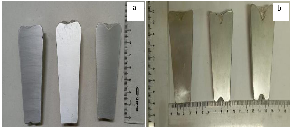
Figura 19: Os seis lingotes cortados ao meio para produção dos corpos de prova. a) lingotes produzidos na CPF. b) lingotes produzidos na coquilha de parede espessa.
