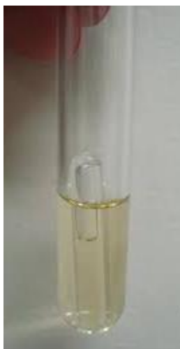
Figura 21: Análise presuntiva através do caldo LST, resultado positivo por conter gás dentro do tubo de Durham.
