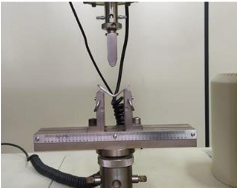
Figura 8: Amostra deformada 15% em flexão a 3 pontos.
