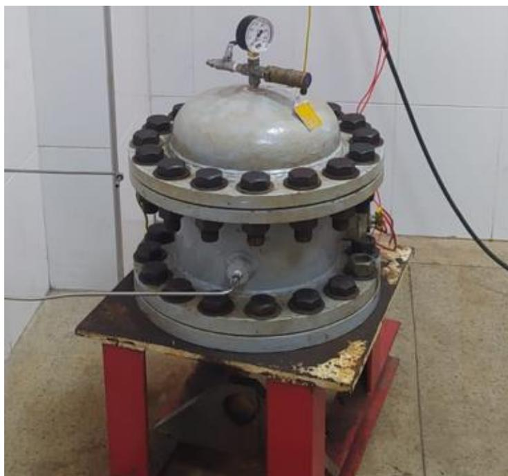
Figura 9: Autoclave para teste de corrosão sob tensão em operação.
