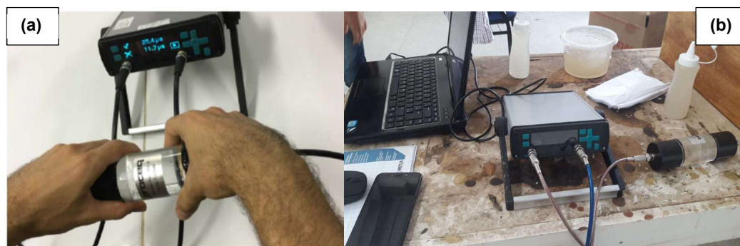
Figura 46 - Procedimento de calibragem do equipamento: no aparelho (a) [75] e pelo programa Punditlink (b).
