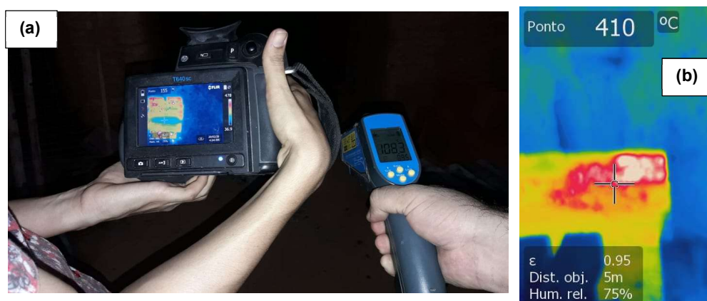
Figura 42 - Termôgrafo e pirômetro usados para medição de temperatura (a); medição de temperatura em um corpo de prova dentro do forno após abertura da janela para sua remoção (b).
