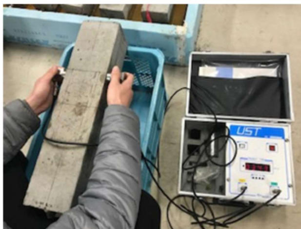
Figura 24 - Caso de ensaio de ultrassom em protótipo de viga [58].
