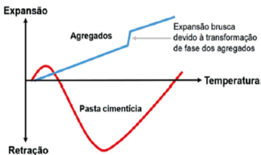
Figura 13 - Incompatibilidade térmica entre agregados e pasta de cimento hidratada [24].
