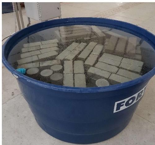
Figura 38 - Corpos de prova cilíndricos, e prismáticos de um estudo correlato [72], em tanque para cura úmida por imersão.
