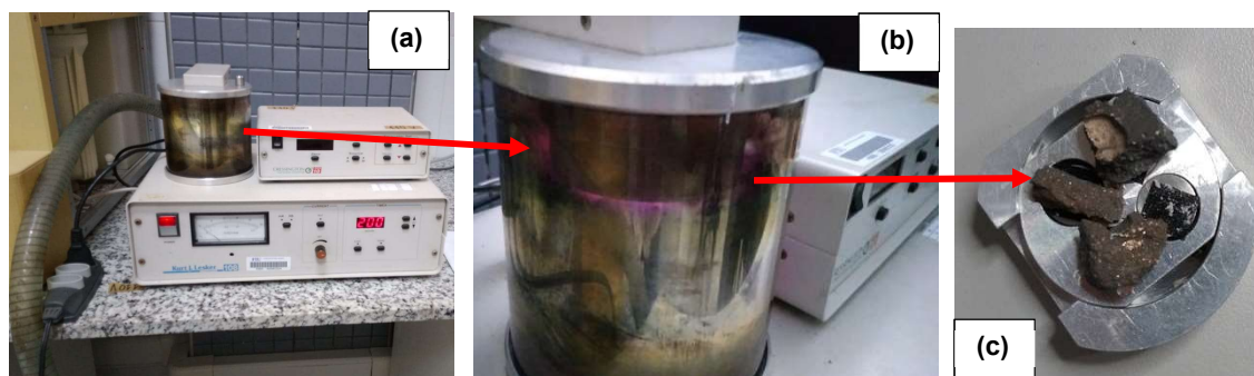
Figura 50 - Metalização das amostras para análise morfológica no MEV (a) e (b); amostras metalizadas posicionadas no porta amostras do MEV (c).
