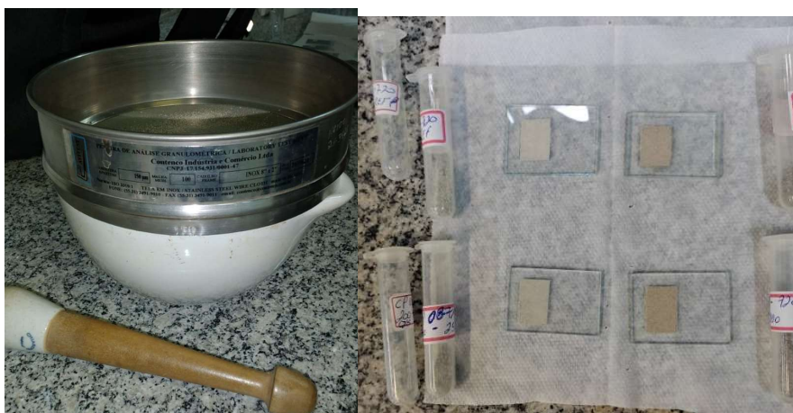
Figura 54 - Amostras em pó (almofariz e pistilo) na peneira #100 (a); Amostras no porta-amostras para uso difratômetro de raios X (b).
