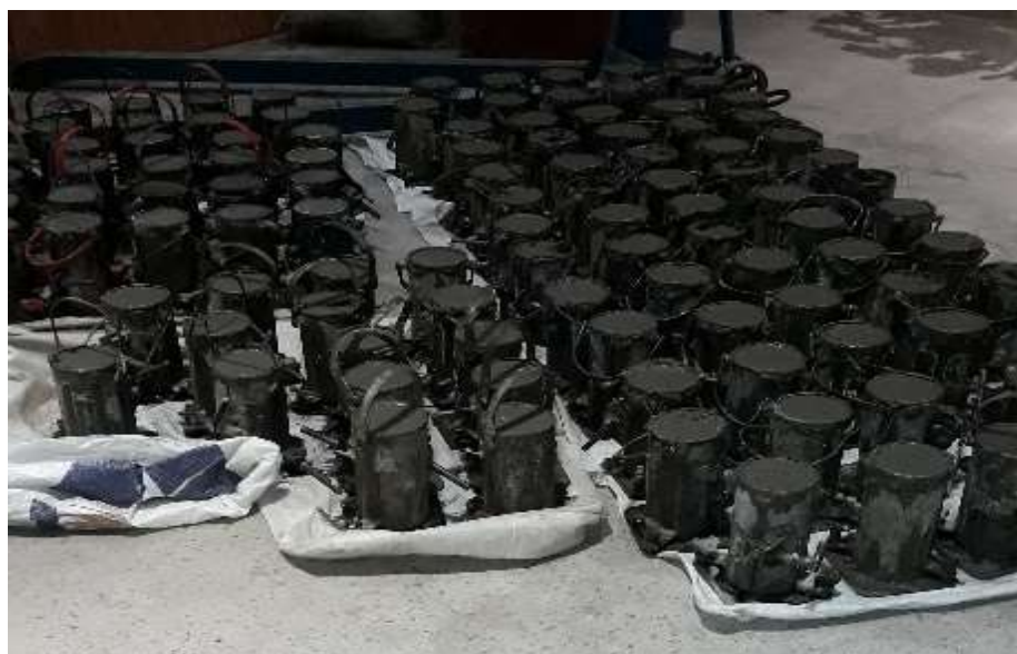
Figura 37 - Concretos após lançamento nos moldes cilíndricos.
