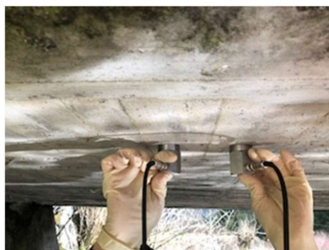
Figura 27 - Caso de transmissão indireta em ensaio de ultrassom no fundo de uma laje [58].
