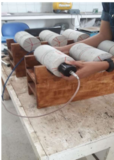
Figura 26 - Caso de transmissão direta em ensaio de ultrassom de corpos de prova de concreto do presente estudo.
