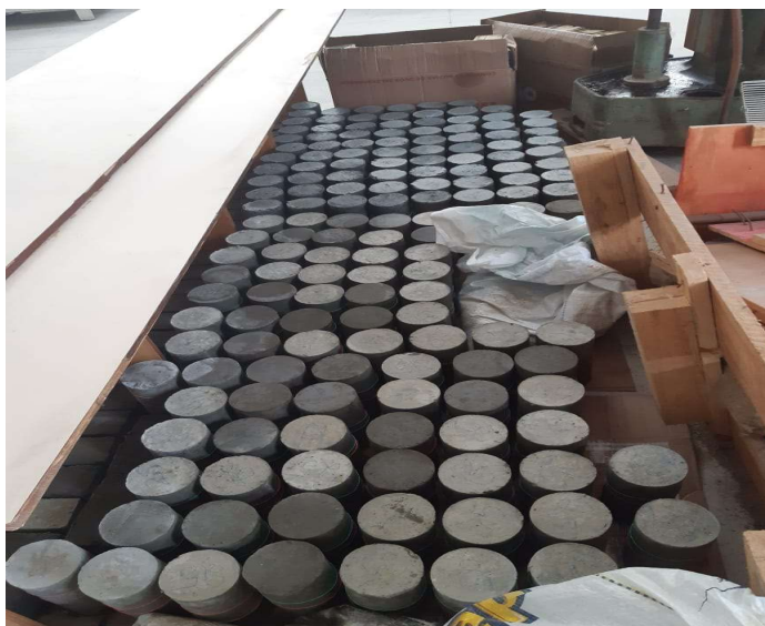
Figura 39 - Corpos de prova em secagem na temperatura ambiente até a idade de exposição ao fogo.
