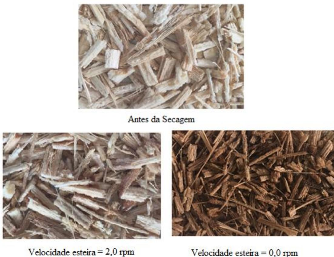
Figura 4.13 – Alteração da cor do bagaço de cana para secagem com velocidade da esteira de 2,0 rpm e 0,0 rpm.
