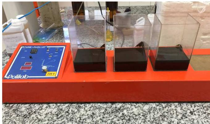
Figura 13-Aparelho Jar Test utilizado como misturador.
