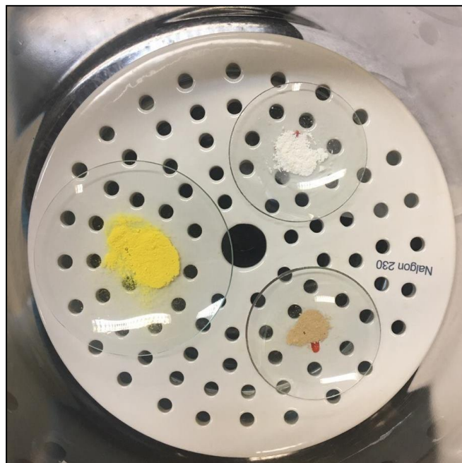
Figura 7 – Aparato experimental utilizado para estudo da cinética de adsorção. NH 2 -MIL-125 (amarelo), MIL-160 (branco) e peneira molecular (marrom).
