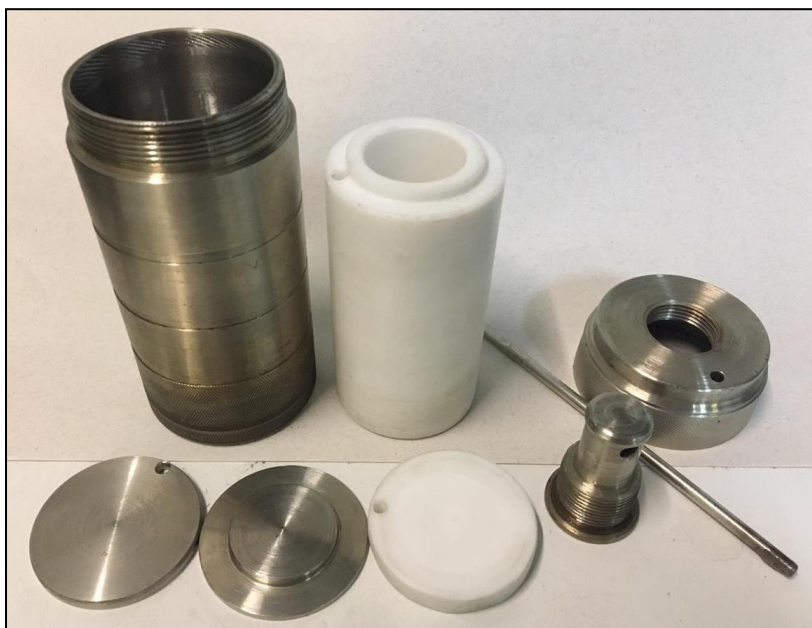
Figura 6 – Mini-reator de teflon e seu revestimento metálico desmontados. Fonte: Elaborado pelo autor
