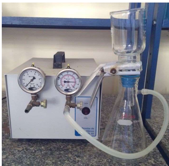
Figura 14: Sistema de filtração. Bomba de vácuo da Solab, modelo SL-61
