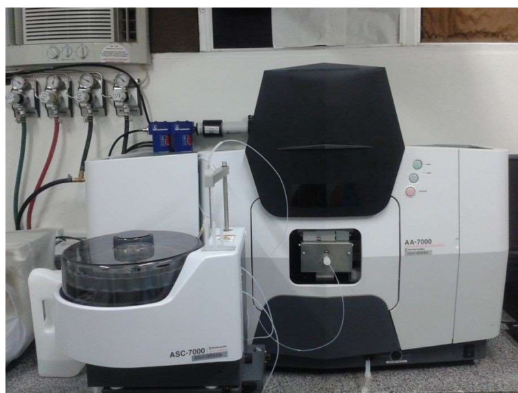
Figura 15: Espectrofotômetro de Absorção Atômica, Shimadzu, modelo AA-700.
