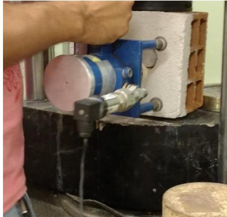
As cargas de rupturas foram anotadas, os corpos de prova foram medidos com paquímetro e foram calculadas as áreas superficiais. Foi examinada e registrada a forma de ruptura do corpo de prova, que deve ser expressa em porcentagem e apresentada junto com o valor da resistência de aderência (ruptura no substrato, na interface substrato/ argamassa, na argamassa ou falha na colagem da peça metálica).
