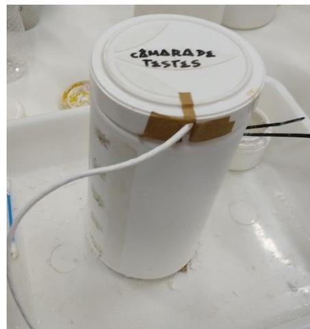
Foram realizadas 5 medições de 10 minutos cada (tempo máximo permitido pelo aparelho) para cada corpo de prova, totalizando 15 medições para cada tipo de argamassa. Após cada medição, o aparelho informava os dados de todas as propriedades térmicas citadas no Quadro 3. Esses dados eram devidamente anotados e iniciava-se a próxima leitura.
