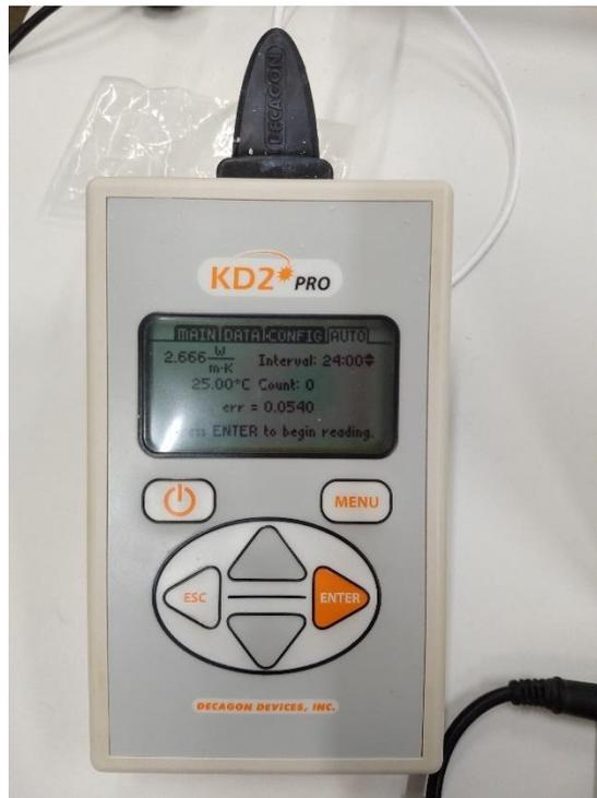
Foram moldados 3 corpos de prova para cada tipo de argamassa estudada, totalizando 12 corpos de prova cilíndricos com diâmetro de 5 cm e altura de 10 cm. O aparelho KD2 Pro possui alguns sensores e para a presente pesquisa foi escolhida a sonda SH-1 por permitir a aquisição de dados de um maior número de propriedades térmicas. No Quadro 3, são apresentadas as especificações dessa sonda.
