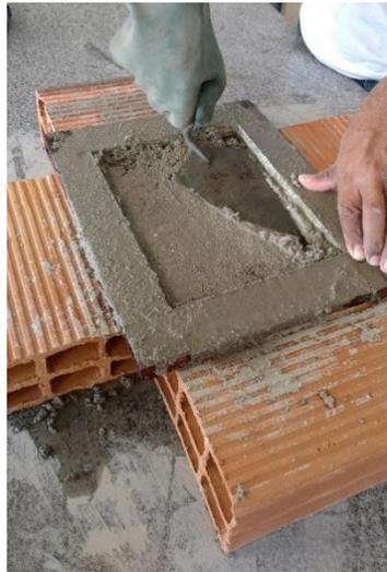
De acordo com a norma NBR 15258 (ABNT, 2005g) devem ser ensaiados dez corpos de prova, distribuídos no substrato, espaçados em no mínimo 40 mm das bordas e no mínimo em 20 mm entre si. Para essa pesquisa foram revestidos 6 blocos, o que resultou em 12 corpos de prova para cada tipo de argamassa. Sendo que dos 12 corpos de prova, apenas 10 deles foram ensaiados, conforme determina a referida norma.
