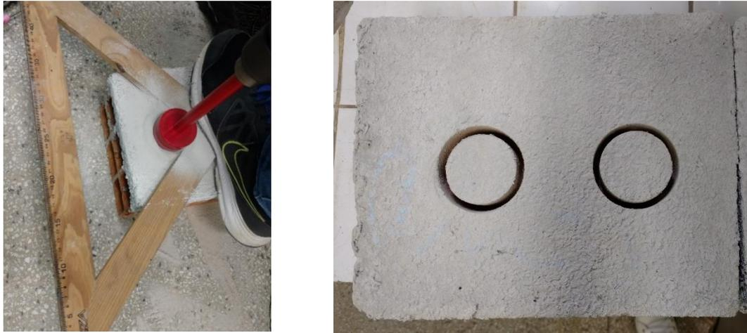
Em seguida, as superfícies foram limpas com uma escova, pois as mesmas deveriam estar livres de qualquer resíduo. Posteriormente, foi realizada a colagem da pastilha metálica com cola epóxi, pressionando-se a pastilha de maneira que a cola ficasse totalmente espalhada entre a pastilha e a argamassa (Figura 13).
