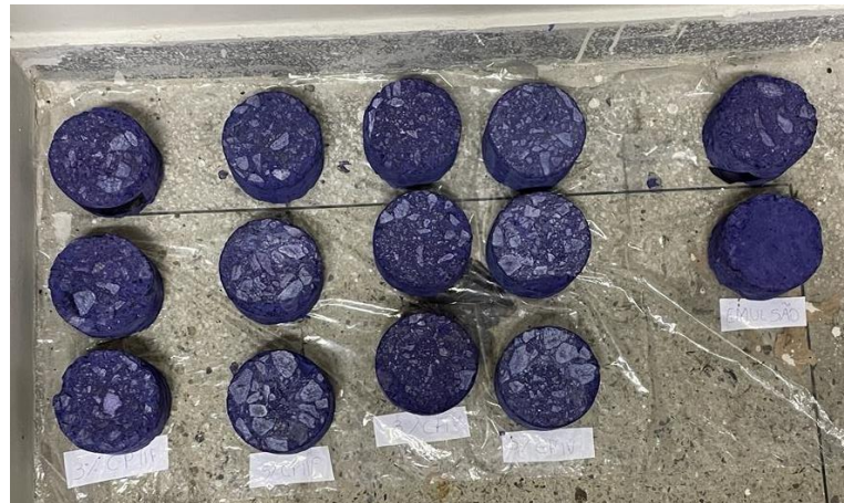
Figura 57 – Corpos de prova em processo de secagem
