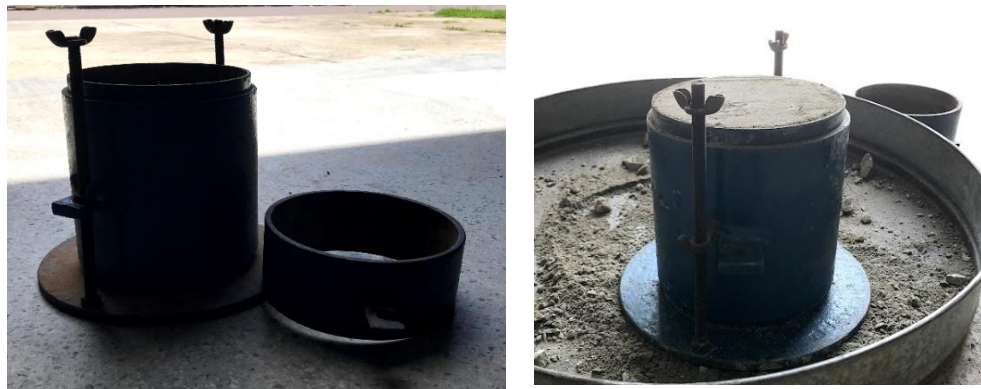
Figura 35 – Molde de compactação com amostra compactada
