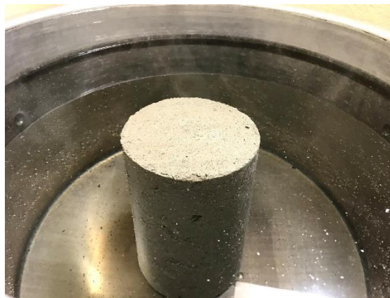
Figura 52 – Corpo de prova levado ao fogo para etapa de ebulição
