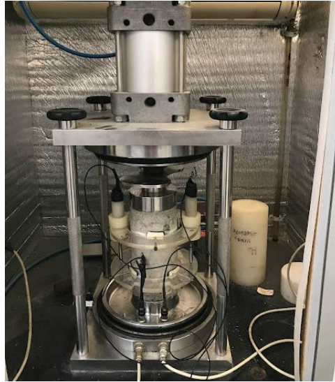
Figura 51 - Configuração do ensaio de módulo de resiliência
