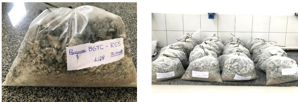
Figura 38 – Mistura de agregados para moldagem dos corpos de prova
