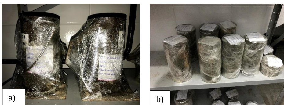
Figura 39 – Corpos de prova em câmara úmida: a) Conjunto corpo de prova e molde envoltos em filme de PVC. b) corpo de prova envolto em filme de PVC
