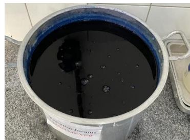
Figura 56 - Corpos de prova imersos na solução aquosa de azul de metileno
