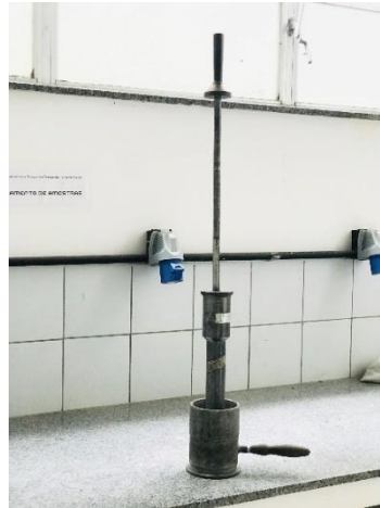
Figura 42 – Molde e cilindro utilizado no ensaio de RTCD
