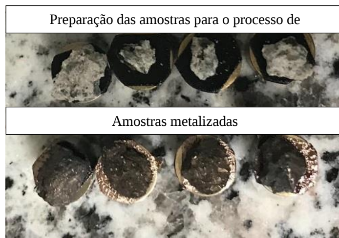
Figura 53 - Amostras metalizados e amostras preparadas para o processo de metalização
