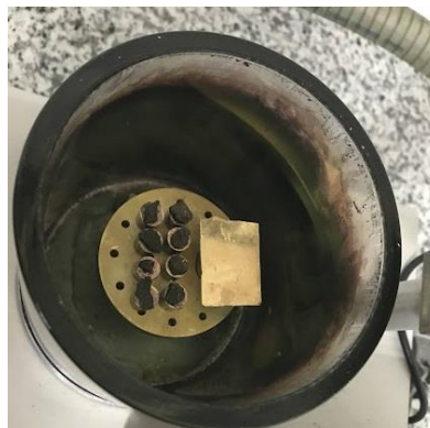
Figura 54 – Amostras no equipamento para metalizar com ouro
