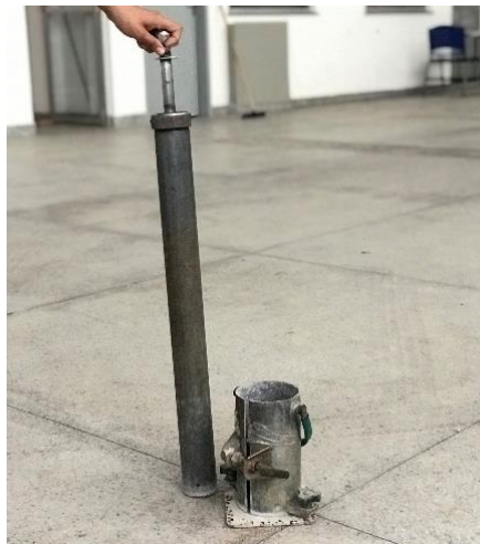
Figura 40 – Molde e cilindro utilizando no ensaio de RCS
