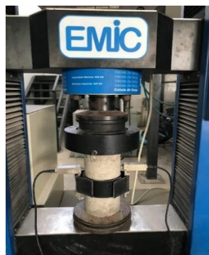
Figura 50 – Instrumentação para ensaio de módulo de elasticidade
