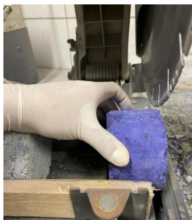
Figura 58 – Corte no corpo de prova
