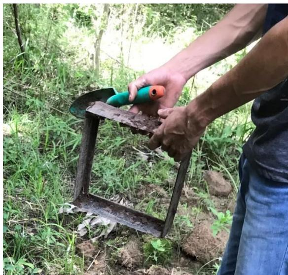
FIGURA 3. Gabarito metálico utilizado para a extração de amostras de banco de sementes do solo.
