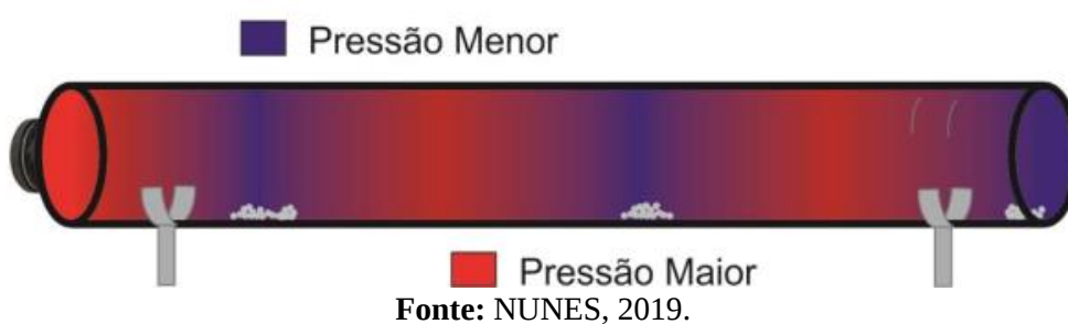
Figura 3.3.6. Esquematização das regiões de baixa e alta pressão dentro do tubo de Kundt.
