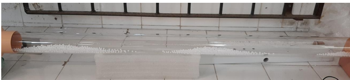
Figura 4.1.16. Ondas estacionárias formadas dentro do tubo.
