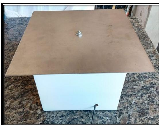
É importante certificar-se de que a placa esteja nivelada para não correr o risco de, no momento da vibração dos grãos, estes se deslocarem mais para um lado, e inclusive, fazendo com que boa parte dos grãos não permaneçam sobre a placa, impedindo a visualização completa das figuras de Chladni.
