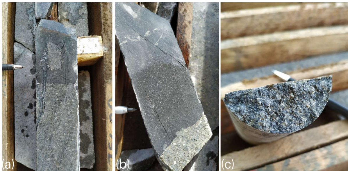
Figura 15. a;b) Furo MBS-1079 - contato litológico abrupto entre o dique máfico e o olivina ortopiroxenito, com presença de xenólito; c) Furo MBS-1021 - olivina ortopiroxenito com textura fanerítica bem preservada.
