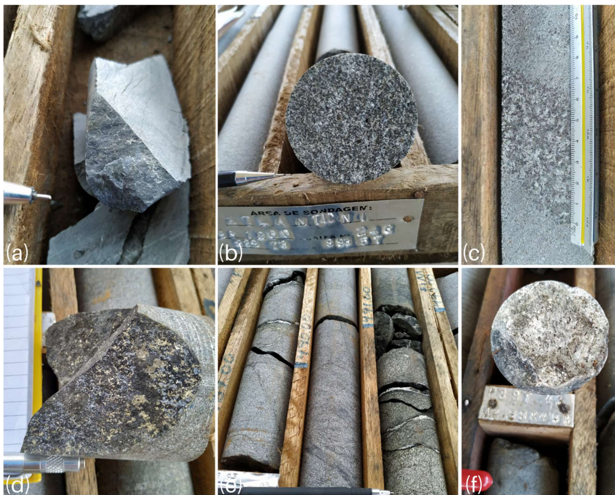
Figura 19. a) Furo MBS-1079 - dique máfico de textura afanítica da zona de contato litológico; b) Furo MBS-1060 - dique máfico de textura fanerítica e granulometria fina (~1 mm); c) Furo MBS-1079 - dique máfico com aumento granulométrico em nível de aproximadamente 6 cm; d) Furo MBS-1043 - dique máfico com presença de sulfetos remobilizados próximo ao contato litológico; e; f) Furos MBS-1043 e MBS-1080 - dique máfico com evidência de cloritização e precipitação de \text{CaCO}_3 .
