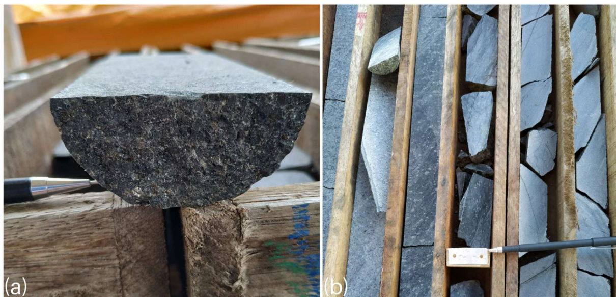
Figura 14. a) Furo MBS-1028 (não utilizado neste trabalho) - harzburgito com textura bem preservada. b) Furo MBS-1021 - intervalo entre o harzburgito e o dique máfico. O contato litológico não está bem delimitado, uma vez que o intervalo ocorre bem fraturado.
