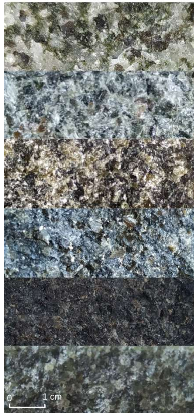
Figura 8. Sequência estratigráfica da IFM (ordem crescente de f para a). (a) Gabronorito □ (b) Websterito □ (c) Ortopiroxenito □ (d) Olivina ortopiroxenito □ (e) Harzburgito □ (f) dunito (modificado de Ferreira Filho et al, 2013). Imagem criada a partir de recortes de furo de sondagem descritos neste trabalho.
