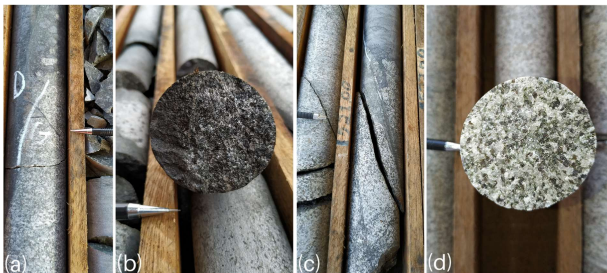
Figura 18. a; b) Furo MBS:104 -: contato litológico entre o gabronorito e o dique máfico. Nota-se um contato abrupto a irregular com ocorrência de uma a) borda de fusão e formação de um b) halo de alteração; (c) Furo MBS-1065 - testemunho de sondagem evidenciando o contato entre o gabronorito, com uralita. d) Furo MBS-1060 - gabronorito com textura fanerítica bem preservada e granulometria grossa.
