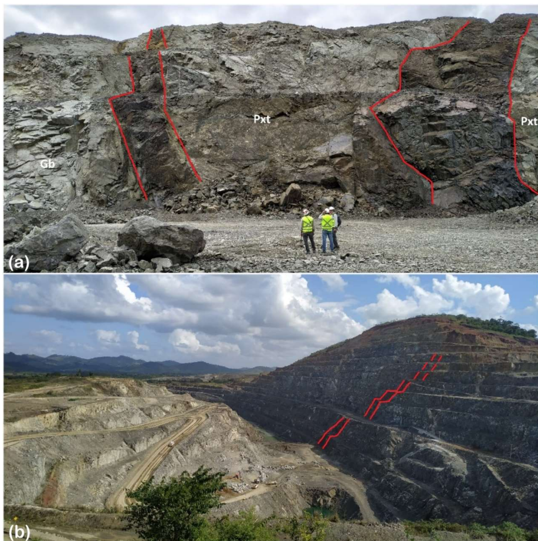
Figura 10. a) – Afloramento leste (parede leste) do dique máfico da Mina Santa Rita. O dique bifurca em dois segmentos; b) – Parede oeste da Mina Santa Rita, com destaque para o comprimento do dique máfico de Santa Rita.
