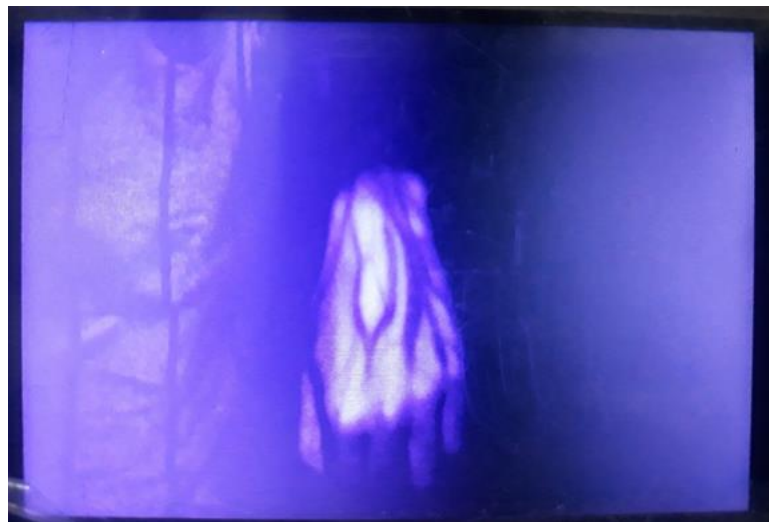
Figura 25 – Resultado do protótipo VV02A ao visualizar a mão esquerda do autor em um cômodo com a presença de luz ambiente.
