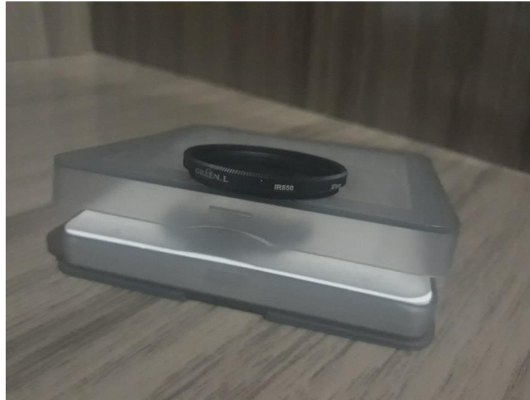
Figura 18 - Ilustração do filtro de 850nm. Está grafado IR850 na borda da lente.
