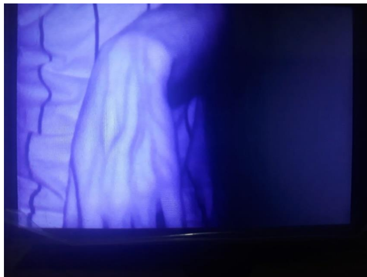
Figura 28 – Resultado do protótipo VV02B ao visualizar o antebraço esquerdo do autor em um cômodo com a presença de luz ambiente.
