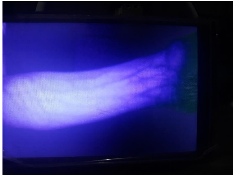
Figura 28 – Resultado do protótipo VV02B ao visualizar o antebraço esquerdo do autor em um cômodo com a presença de luz ambiente.
