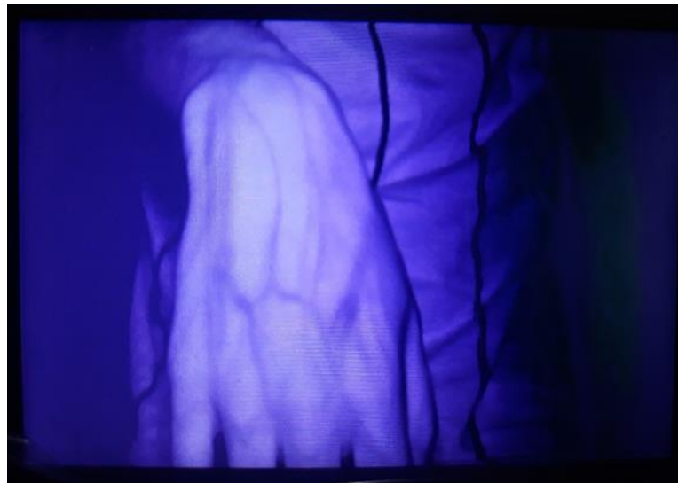
Figura 27 – Resultado do protótipo VV02A ao visualizar a mão direita do autor em um cômodo com a presença de luz ambiente.
