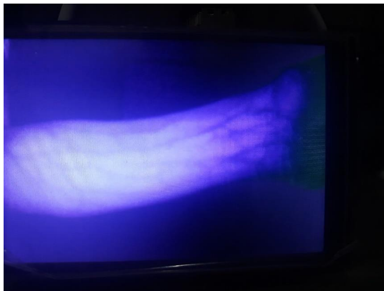
Figura 32 – Resultado do protótipo VV02B ao visualizar o antebraço esquerdo do autor em um cômodo com a presença de luz ambiente.
