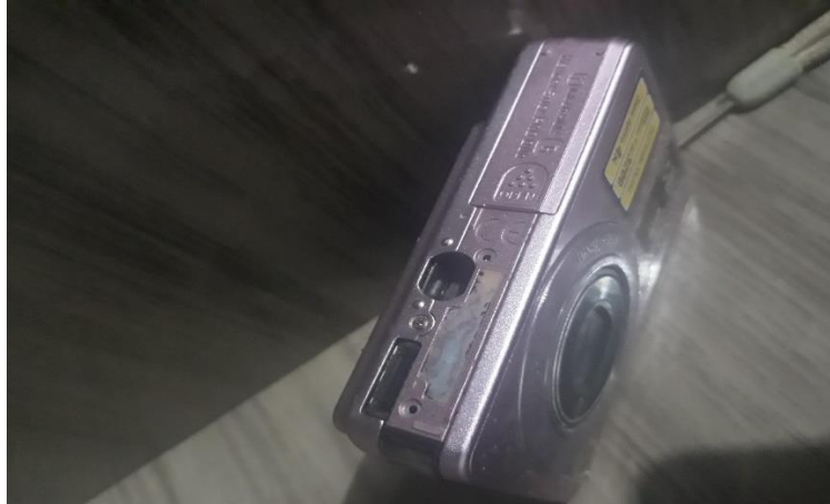
Figura 12 - Câmera apresentando dois buracos referentes a peças não realocadas, devido à dificuldade encontrada na reposição das mesmas durante a remontagem
